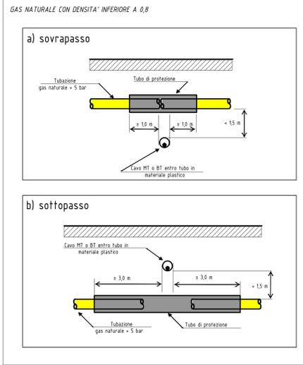
**PARALLELISMI TRA CAVIDOTTI MT-BT E TUBAZIONI GAS NATURALE CON PRESSIONE DI ESERCIZIO MAGGIORE DI 5 BAR NON DRENATE**
