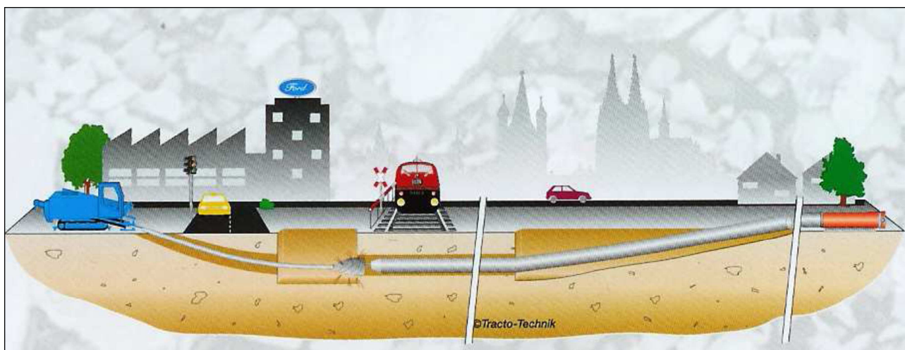
Figura 9 – Schema di principio dell'attraversamento in T.O.C.
