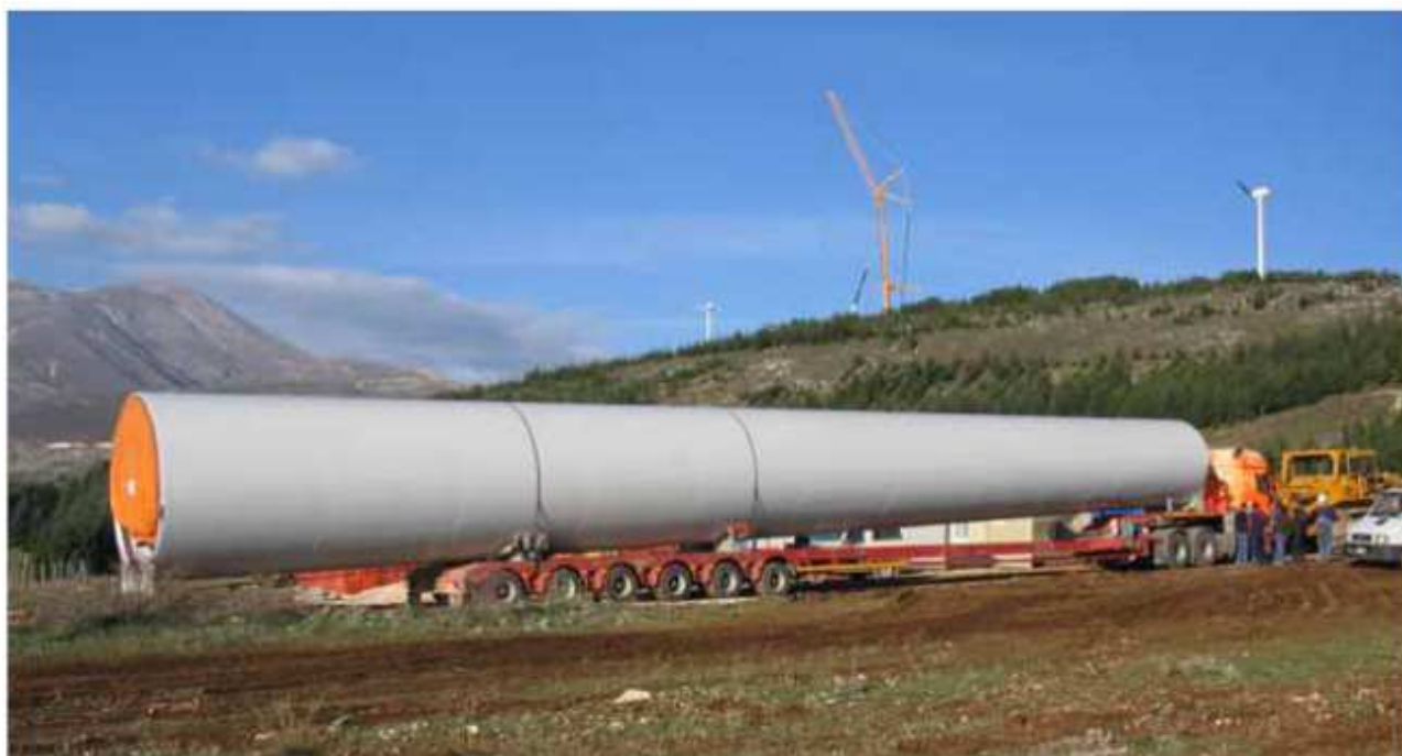
Figura 1 - Esempi dei mezzi di trasporto dei componenti degli aerogeneratori.
