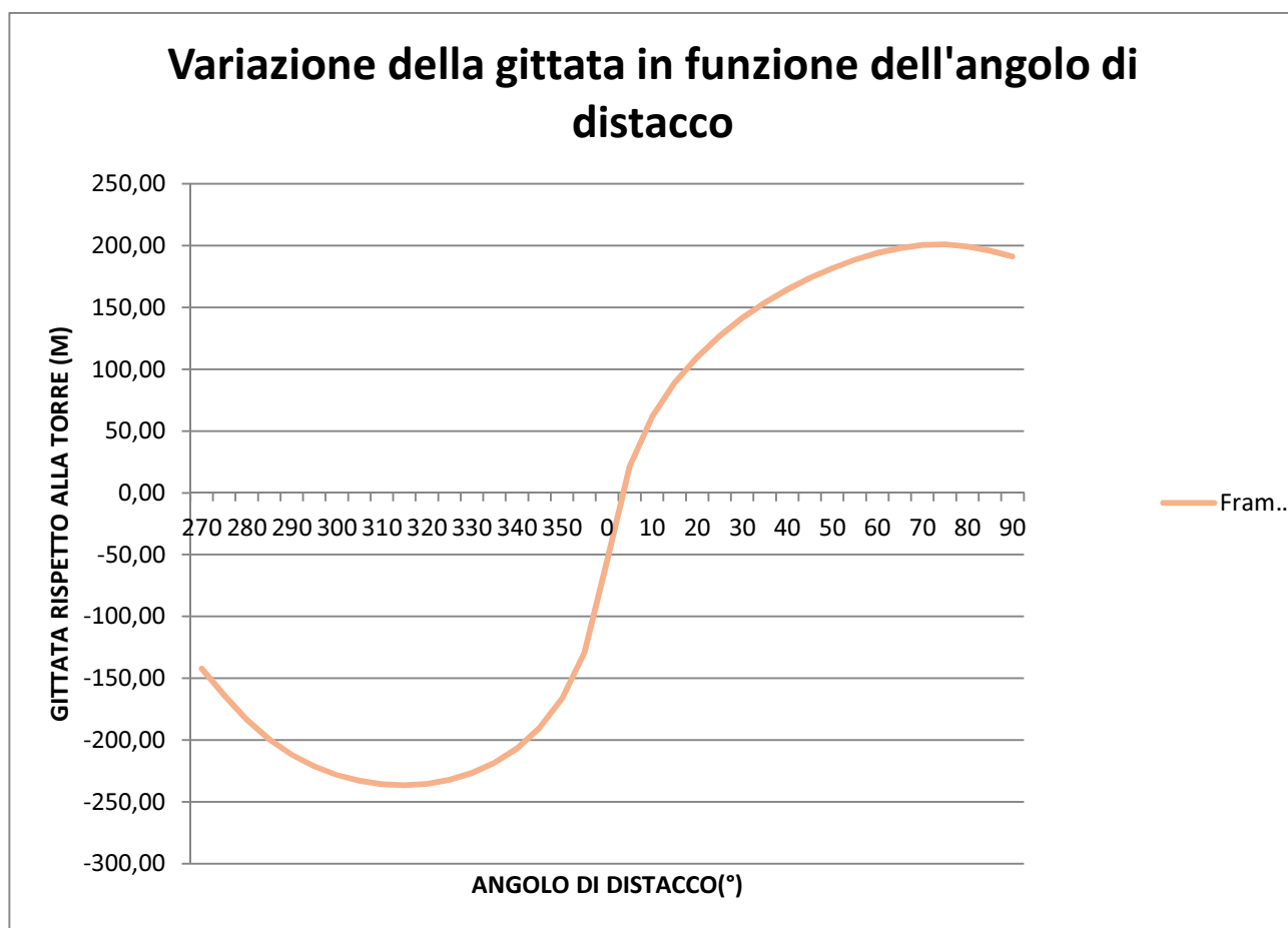
Figura 9 – variazione della gittata in funzione dell'angolo di distacco per la rottura del frammento di pala distante 5 m dalla punta della pala.
