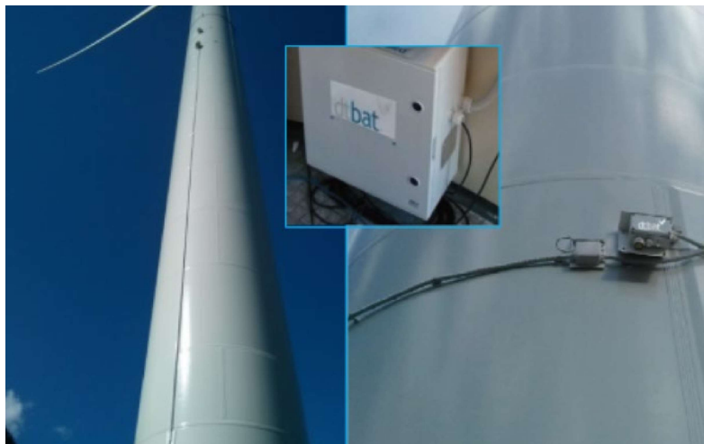
Figura 3. Una turbina eolica equipaggiata con il Detection Module di DTBat® in grado di riconoscere bioacusticamente gli individui frequentanti l’area critica delle pale in movimento e di registrarne il passaggio e l’eventuale “collisione” in una banca dati accessibile anche con wi-fi.
