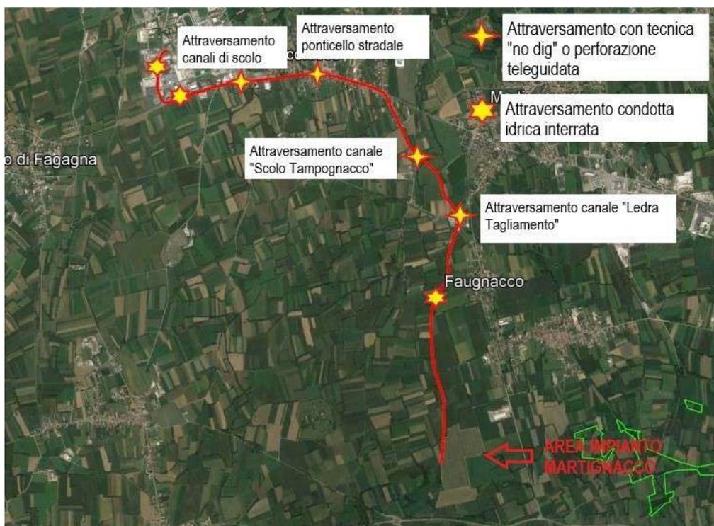
Figura 24: Rilievo delle interferenze su base ortofoto.
