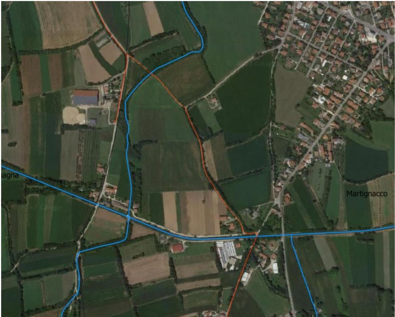
Figura 4. Interferenza del cavidotto con il reticolo idrografico (in rosso il cavidotto posato con tecnica "no-dig")
