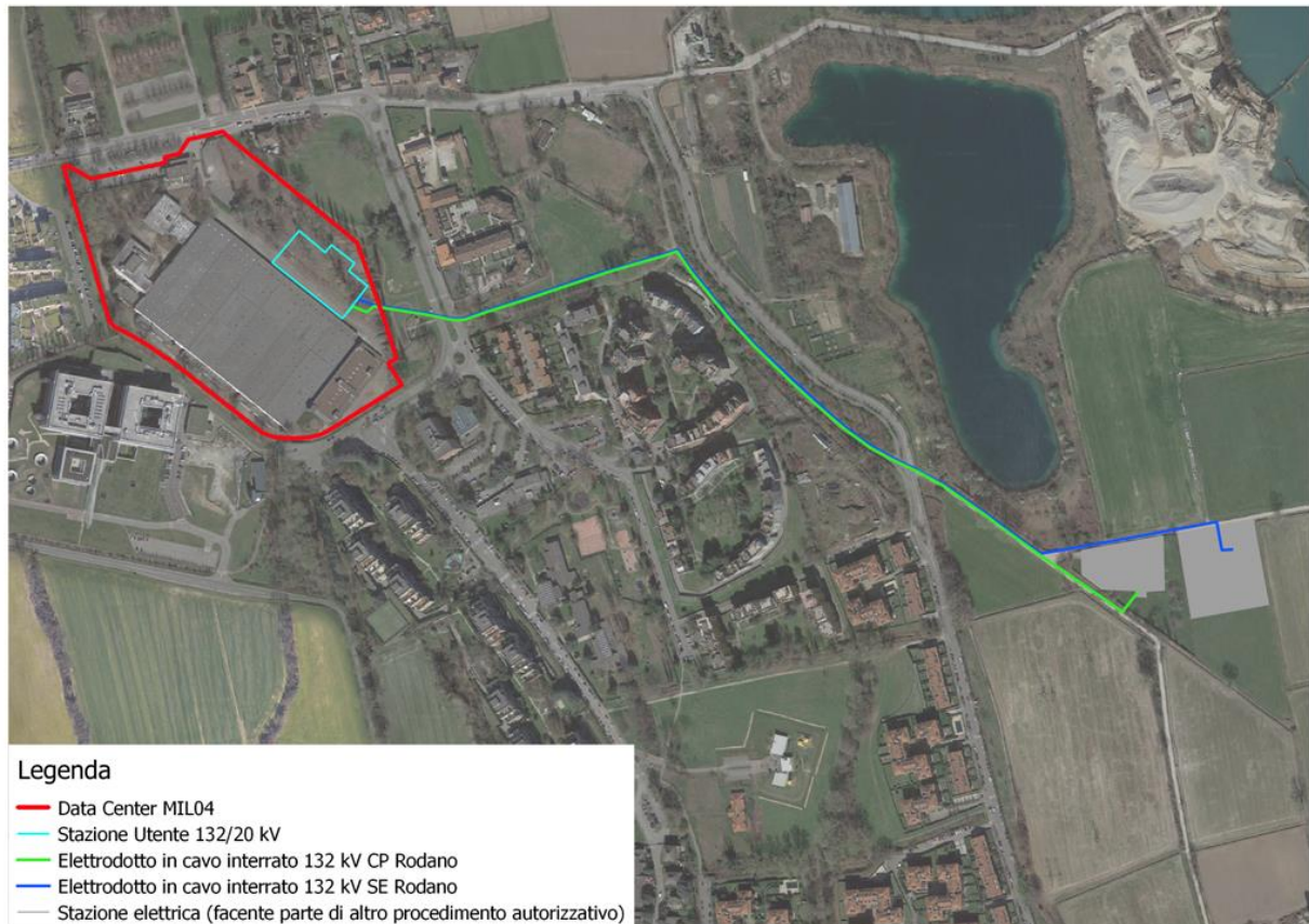
Figura 3-4: Nuova Stazione Utente per MIL04 e collegamento alla Cabina Primaria esistente e alla Stazione Elettrica in progetto nel comune di Rodano
