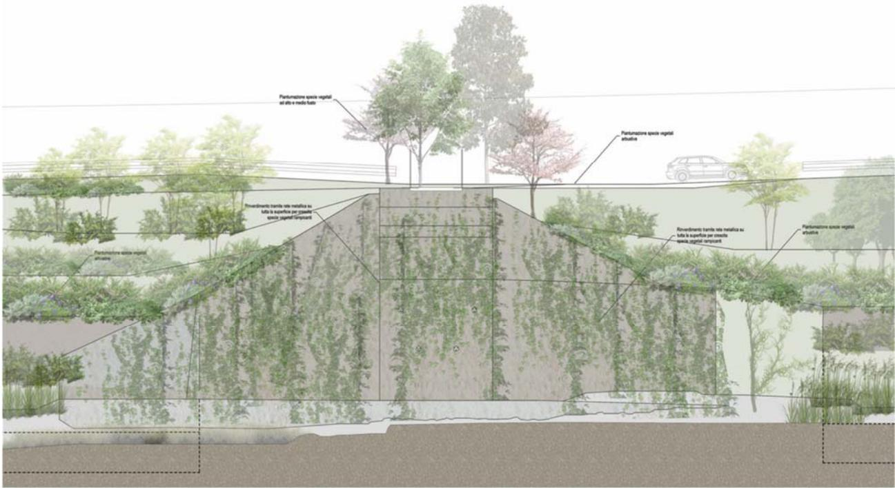
Figura 8 Prospetto della spalla lato Genova. Si notano i rampicanti sulla struttura in calcestruzzo armato
