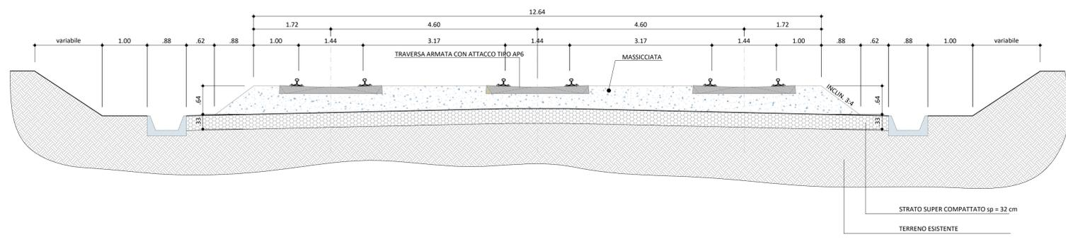
PARTICOLARE SEZIONE TIPO IN SCAVO CON TRVERSE IN CAP
