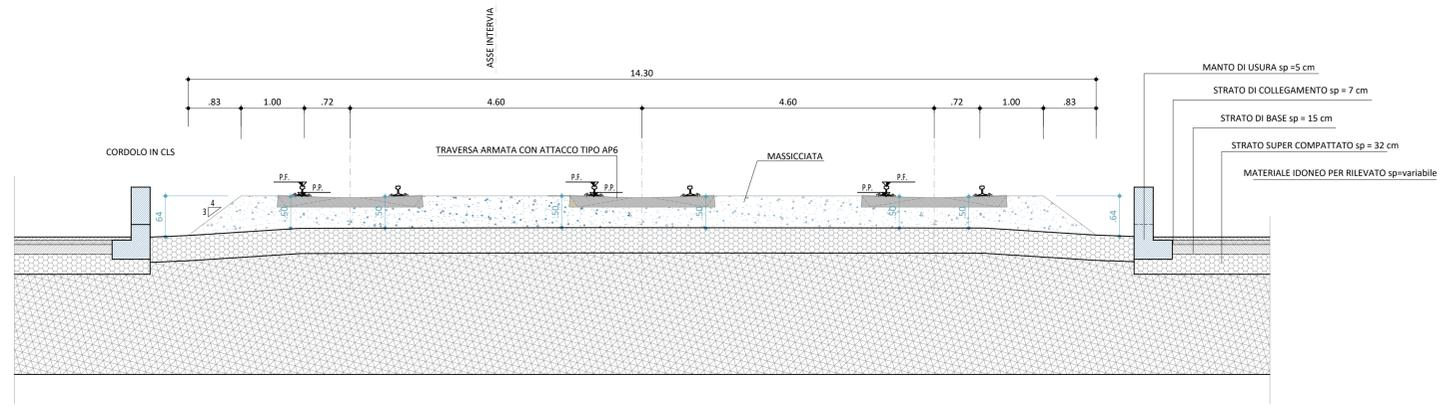
PARTICOLARE SEZIONE TIPO NEL PIAZZALE CON TRAVE IN CAP
