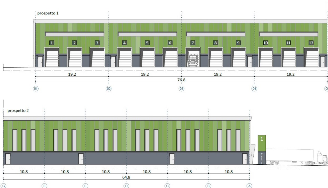
Figura 25 Prospetti capannoni tipo 1
