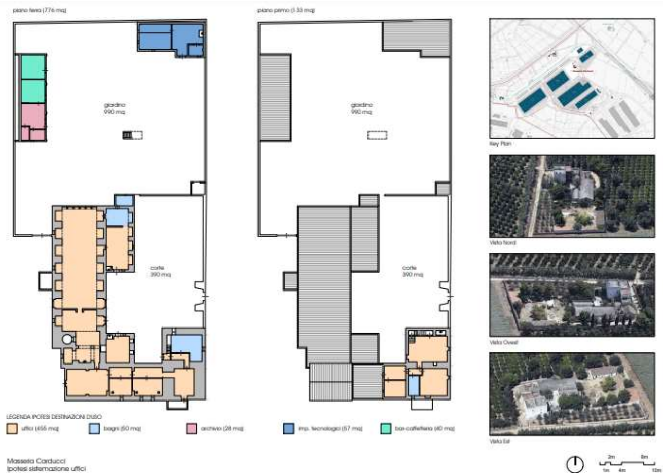
Figura 70 Schema Funzionale recupero Masseria Carducci. Bozza progettuale non oggetto della presente procedura di valutazione, in quanto gli interventi di recupero e rifunzionalizzazione saranno attuati nell'ambito del secondo stralcio dei lavori
