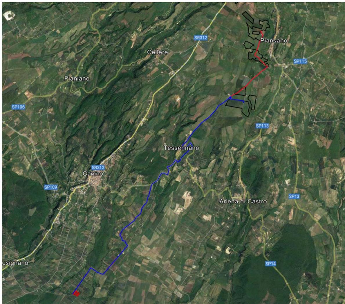
Figura 13 – tracciato cavidotto MT verso nuova SE
