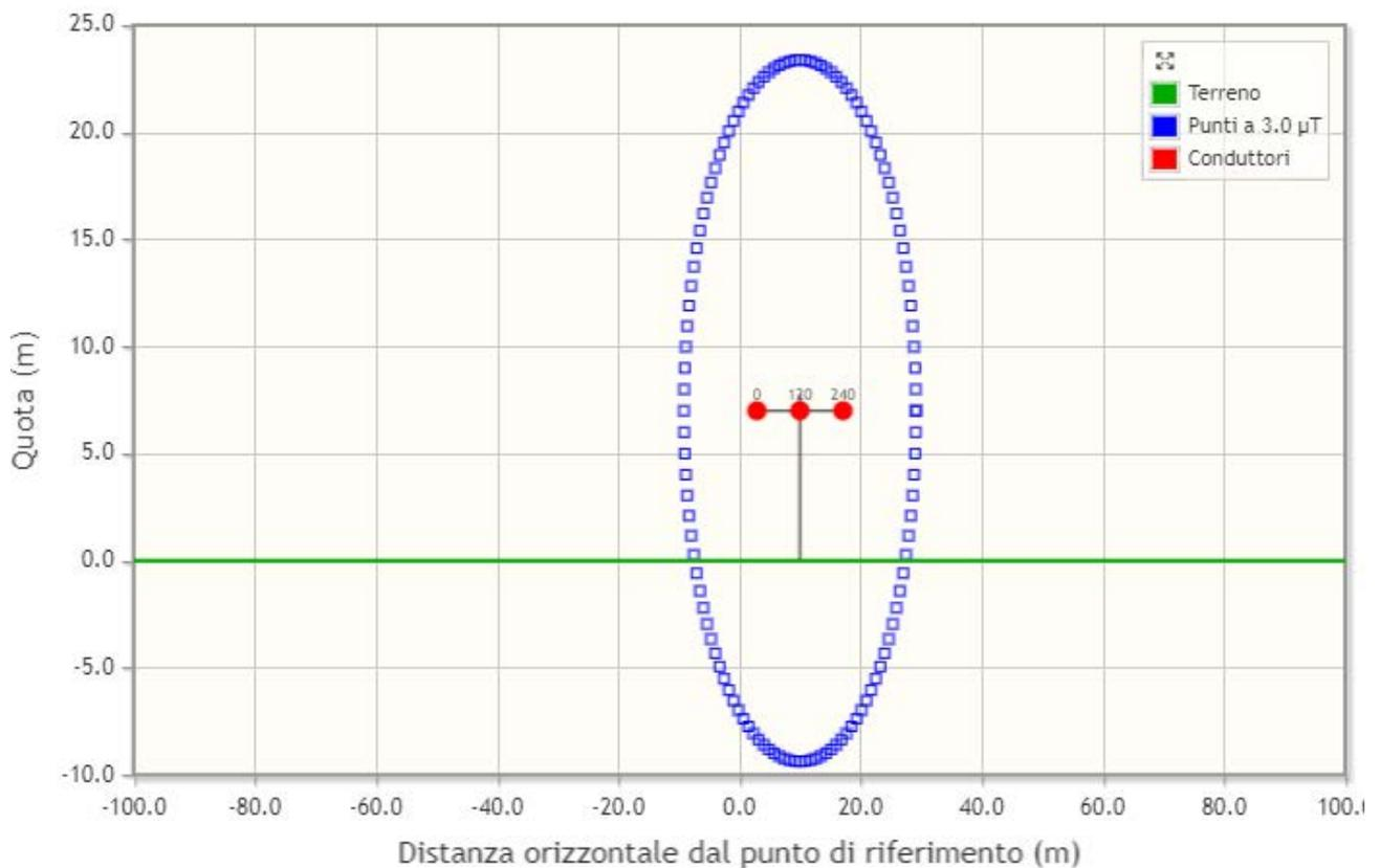
Come si può notare, ad una distanza di 13m dall'asse del sistema di sbarre l'induzione magnetica è inferiore a 3µT.
