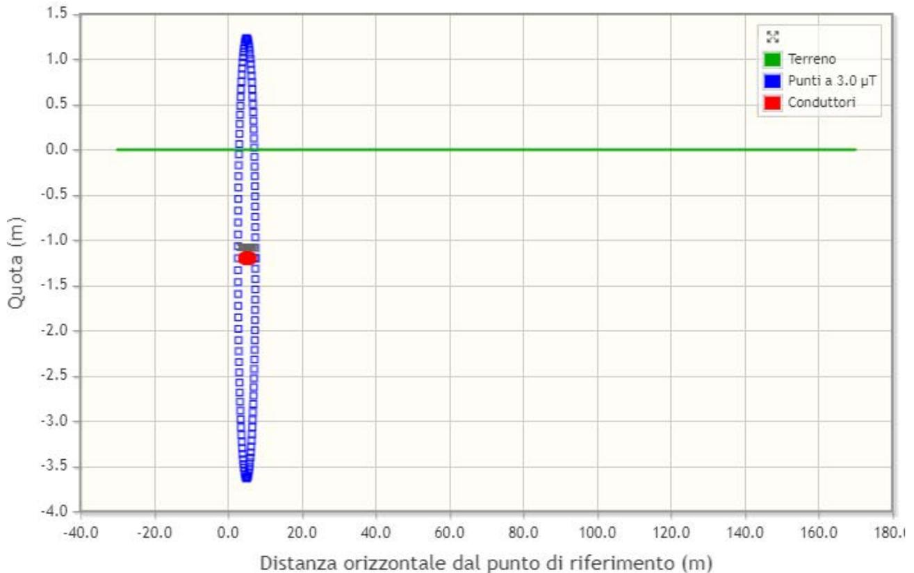
Si può quindi considerare che l'ampiezza della fascia di rispetto con valore del campo magnetico indotto inferiore a  $3\mu\text{T}$  sia pari a 1,20m, a cavallo dell'asse del cavidotto. Infine, poiché in un cavo schermato il campo elettrico esterno allo schermo è nullo, non è rappresentato il calcolo del campo elettrico prodotto dalla linea in oggetto.
