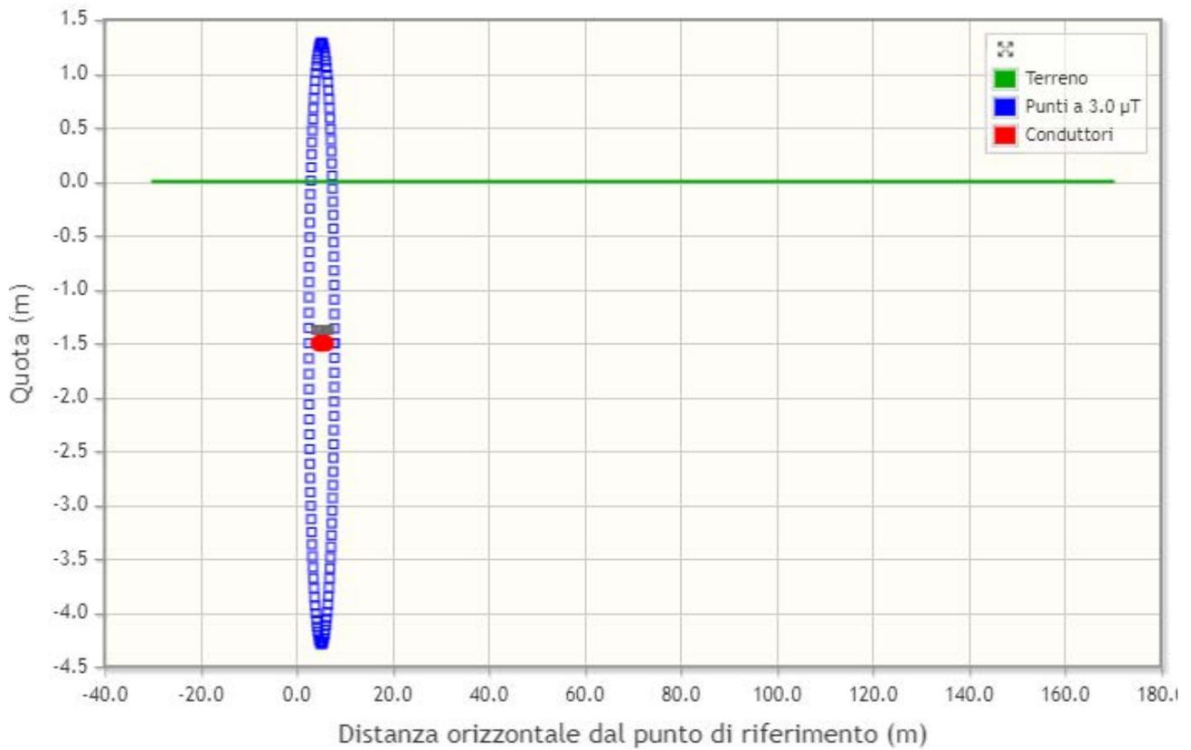
Si può quindi considerare che l'ampiezza della fascia di rispetto con valore del campo magnetico indotto inferiore a  $3\mu\text{T}$  sia pari a 2,7m, a cavallo dell'asse del cavidotto.
