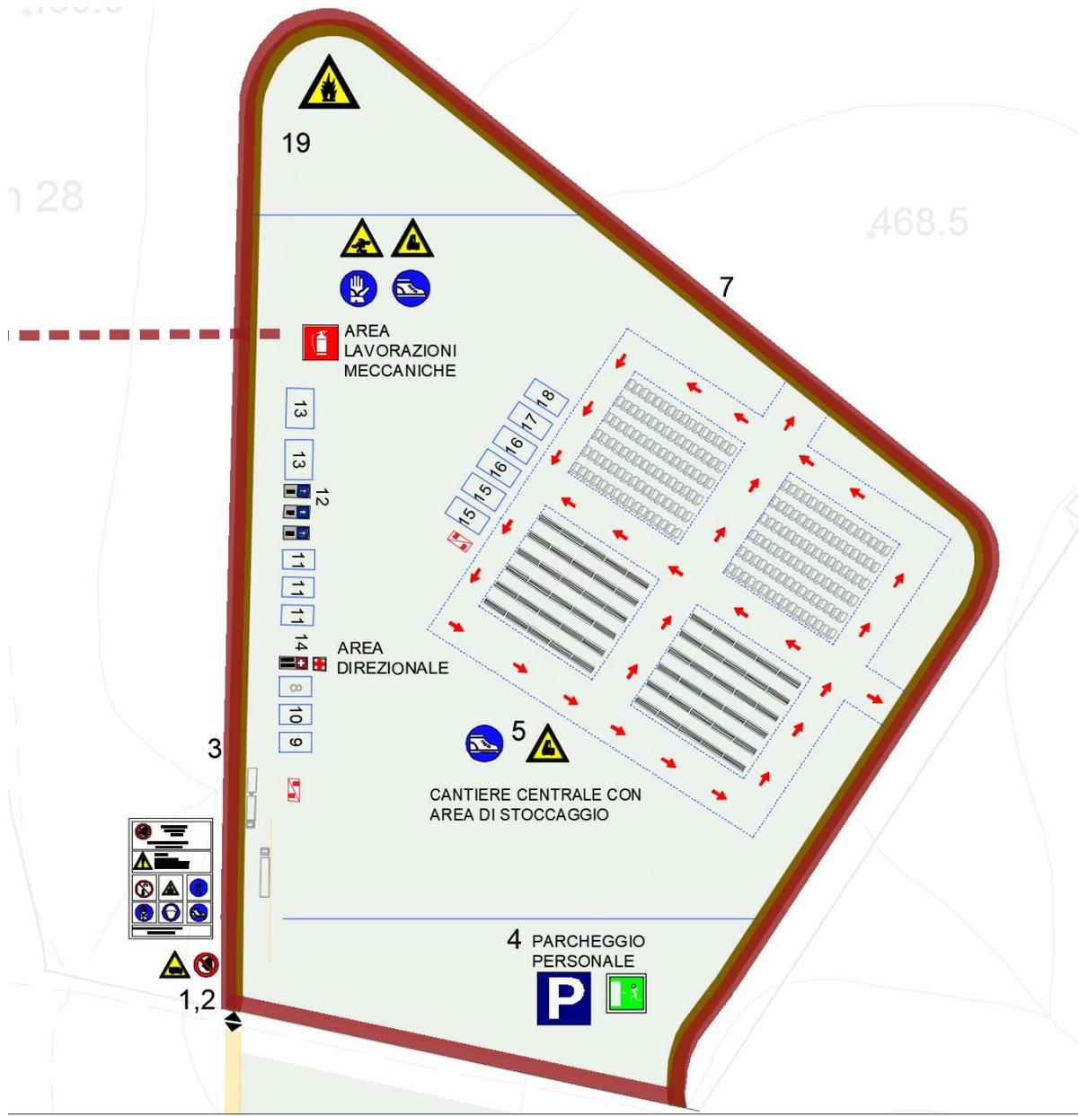
Fig.4 – Ricezione, stoccaggio e movimentazione materiali, dettaglio apprestamenti piastra 1a (cantiere 1)
