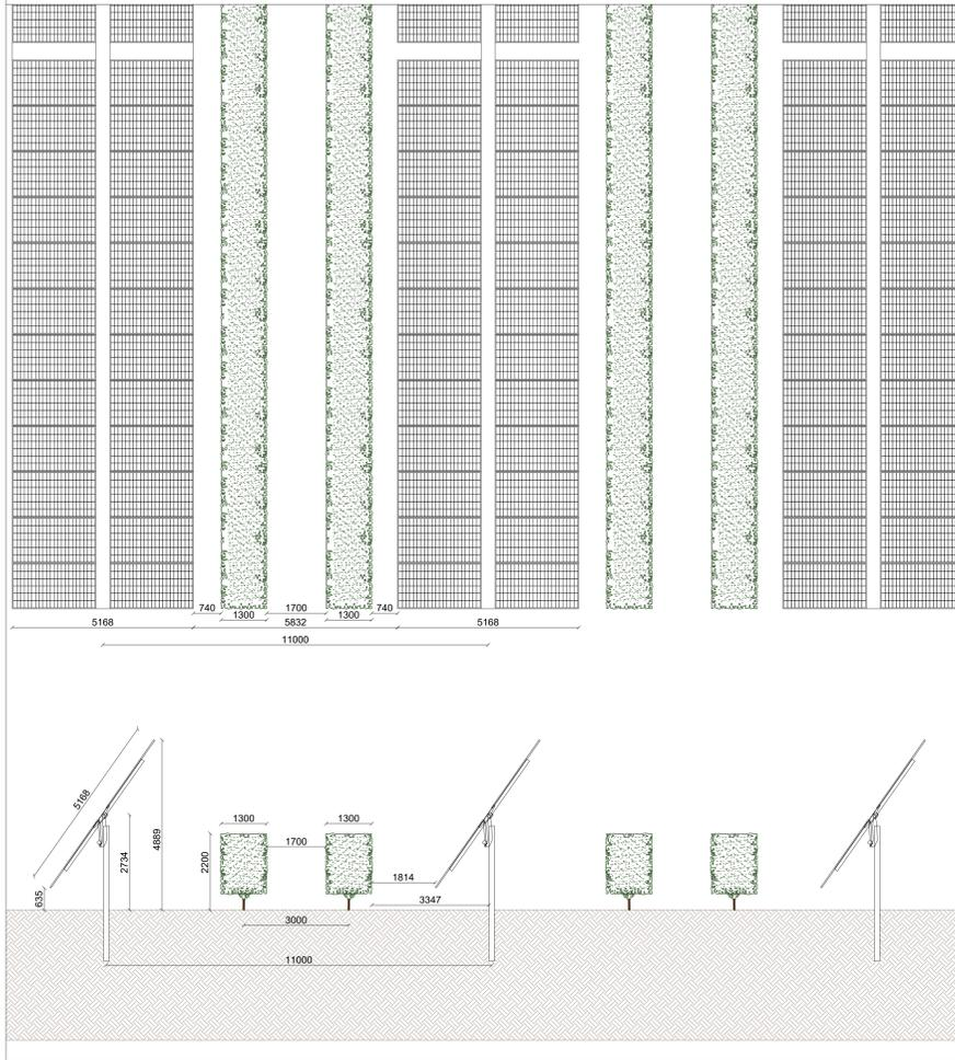
PARTICOLARI PANNELLO FOTOVOLTAICO E STRUTTURA DI SUPPORTO INVERTER
