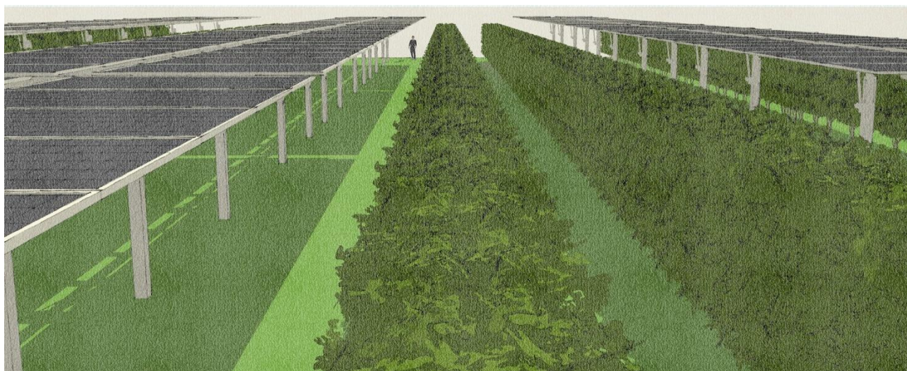
Figura 99 - Schizzo alternanza tra doppie siepi ulivicole e inseguitori FV
