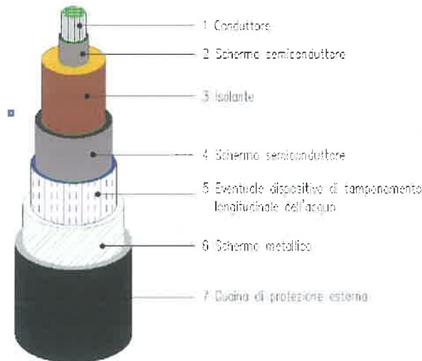
Figura 4: Schema costruttivo del cavo AT
