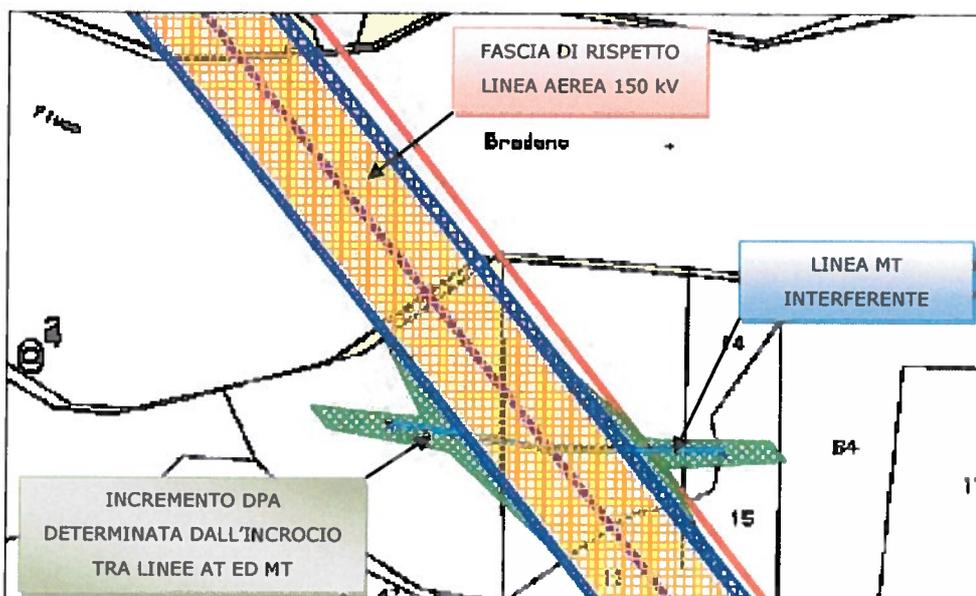
**Figura 8:** Incremento dell'area di prima approssimazione dovuta ad incroci tra linee AT ed MT in corrispondenza dei sostegni N°22 e N°23
