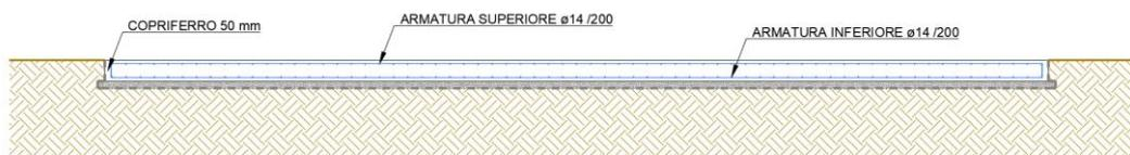
Figura 8 – Sezione B della platea di Fondazione della Power Station
