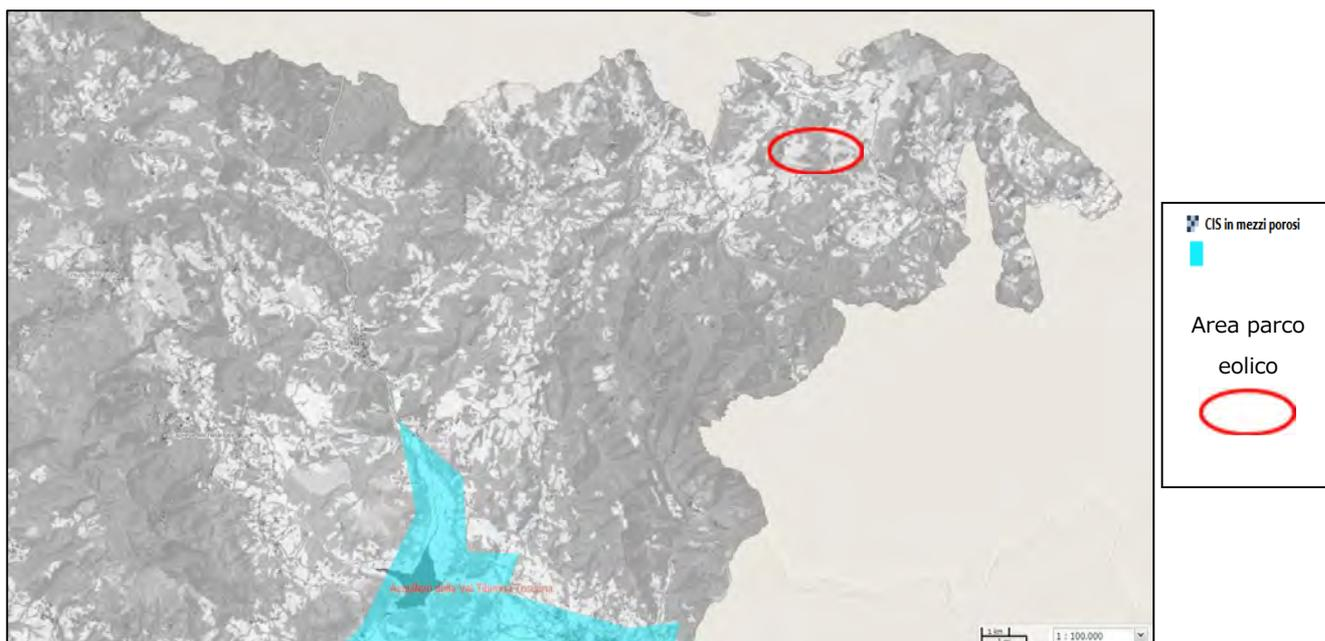
In dettaglio nelle aree in esame vi è l'esistenza di un sensibile contrasto di permeabilità tra la coltre detritica (costituita dai depositi marnoso-arenacei degradati ed alterati) ed il substrato roccioso marnoso-arenaceo integro e/o poco alterato. Le indagini geofisiche svolte presso gli aerogeneratori in progetto ha evidenziato una coltre permeabile per porosità che ha una profondità variabile rispetto all'attuale piano campagna.
