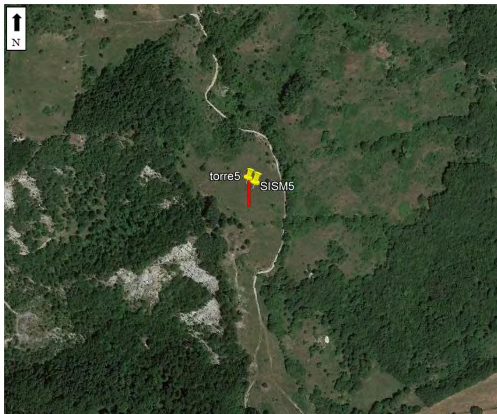
La lunghezza stendimento e' stato di 36 metri, costituito da 12 geofoni verticali di 4,5 Hz, aventi distanza intergeofonica di 3 metri, shot esterni a distanza di 3-5-7 metri dal primo geofono. L' energizzazione è stata ottenuta tramite mazza da 8 kg, battente su piastra metallica.
