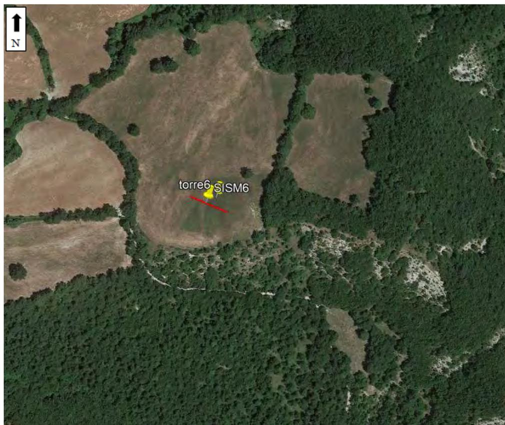
La lunghezza dello stendimento e' stata di 60 metri, costituito da 12 geofoni verticali di 4,5 Hz, aventi distanza intergeofonica di 5 metri, shot esterni a distanza di 3-5-7 metri dal primo geofono. L' energizzazione è stata ottenuta tramite mazza da 8 kg, battente su piastra metallica.
