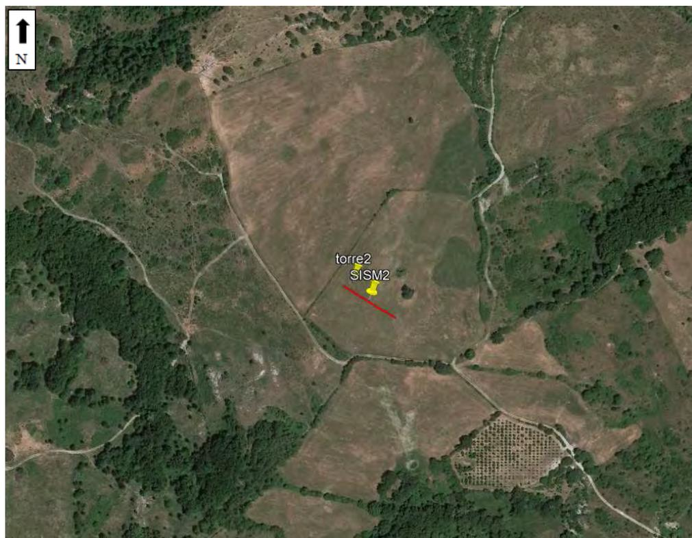
La lunghezza dello stendimento e' stata di 60 metri, costituito da 12 geofoni verticali di 4,5 Hz, aventi distanza intergeofonica di 5 metri, shot esterni a distanza di 3-5-7 metri dal primo geofono. L' energizzazione è stata ottenuta tramite mazza da 8 kg, battente su piastra metallica.
