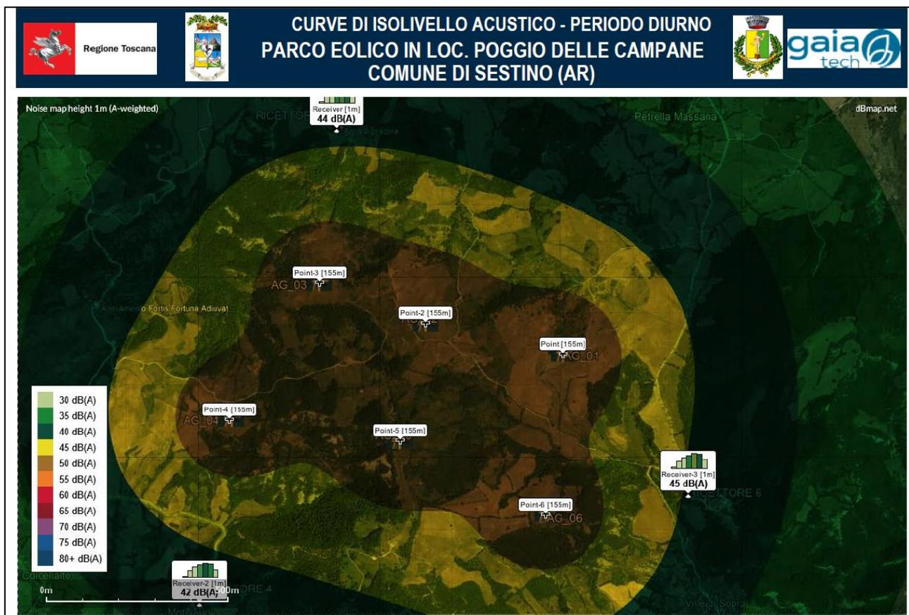
Figura 10 - Curve di isolivello acustico diurno
