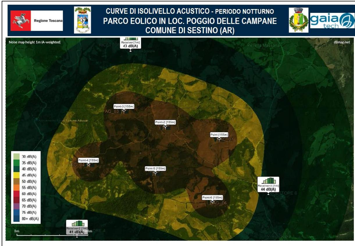
Figura 11 - Curve di isolivello acustico notturno
