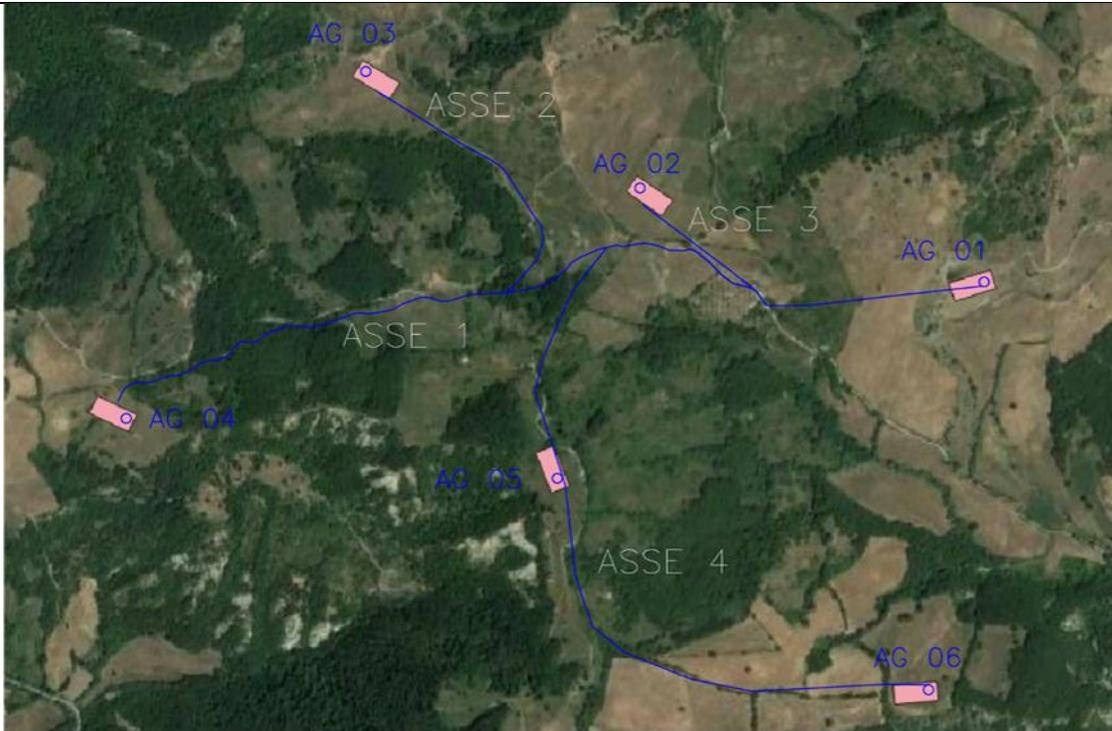
Prima di giungere alla scelta progettuale ed al layout definitivi, a cui si è giunti tramite un processo continuo di affinamento di scelte, valutazioni ed analisi, sono state prese in considerazione più alternative di localizzazione dell'impianto in particolare considerando il posizionamento degli aerogeneratori e la sottostazione, quindi il tracciato del cavidotto.
