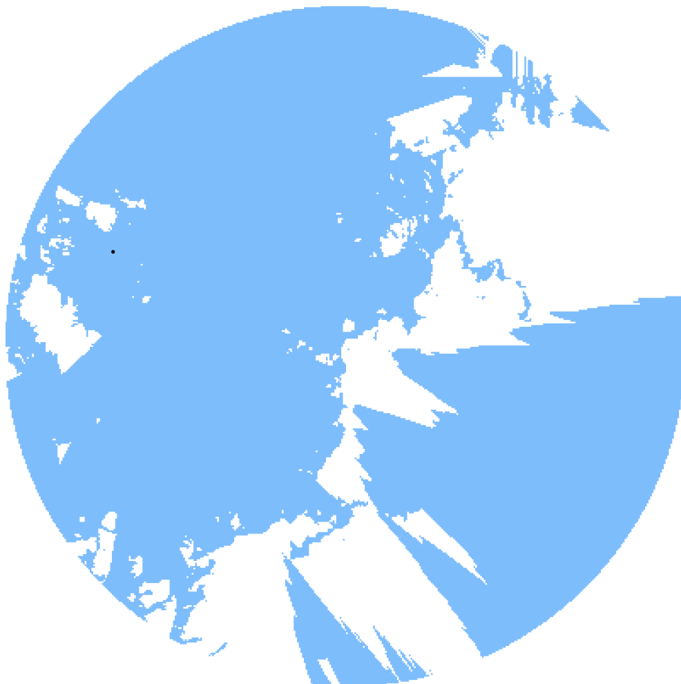
Figura 74 - L'output del software Windfarm relativo alla visibilità del Parco Eolico "Badia dei Venti" in progetto nell'AIP di 10 km di raggio con centro nel centro del Parco Eolico "Sestino".
