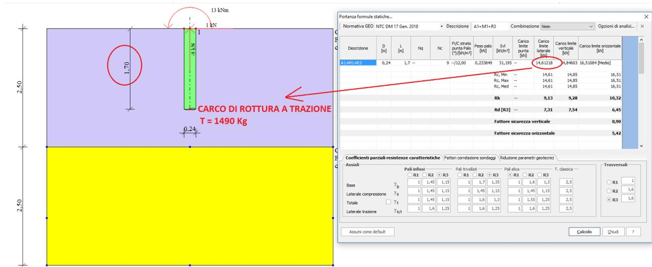
Pertanto, la lunghezza di inclinazione calcolata è  $L_{emb} = 1700 \text{ mm}$  e l'equivalente della massima azione perpendicolare verticale (trazione) è  $N_{max, trac. test} = 1490 \text{ kg}$  ( $\gg N_{max, trac. test} = 1072 \text{ kg}$ ).
