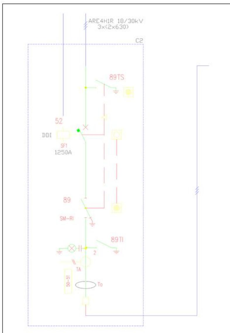
**Figura 9 - Particolare di schema della cabina di parallelo**
