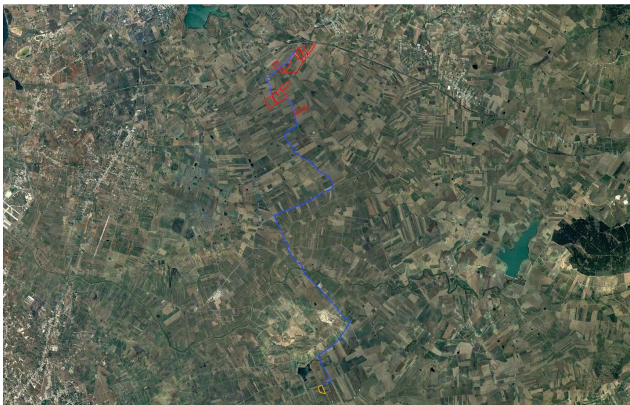
Figura 1 - Inquadramento con percorso del cavidotto di connessione
