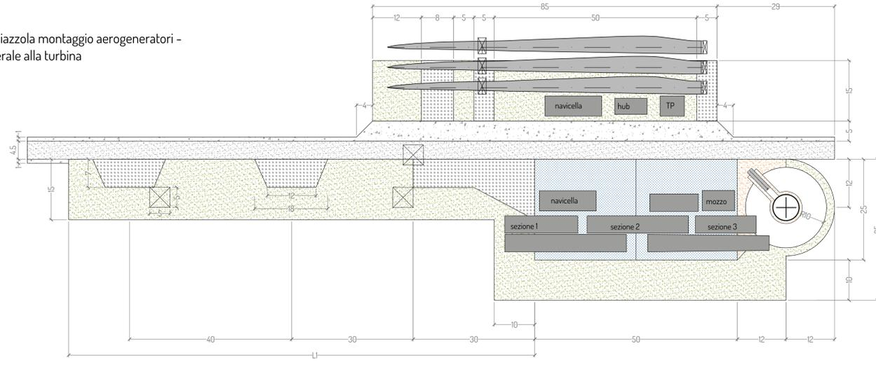
Tipologico piazzola montaggio aerogeneratori - piazzola frontale alla turbina
