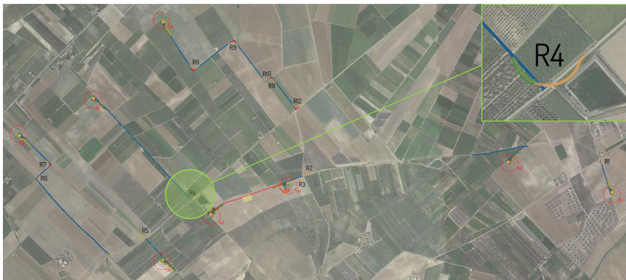
Figura 12: Ulivi da espantare per realizzazione viabilità di cantiere (R4) Rif. Elaborato EG.2.1
