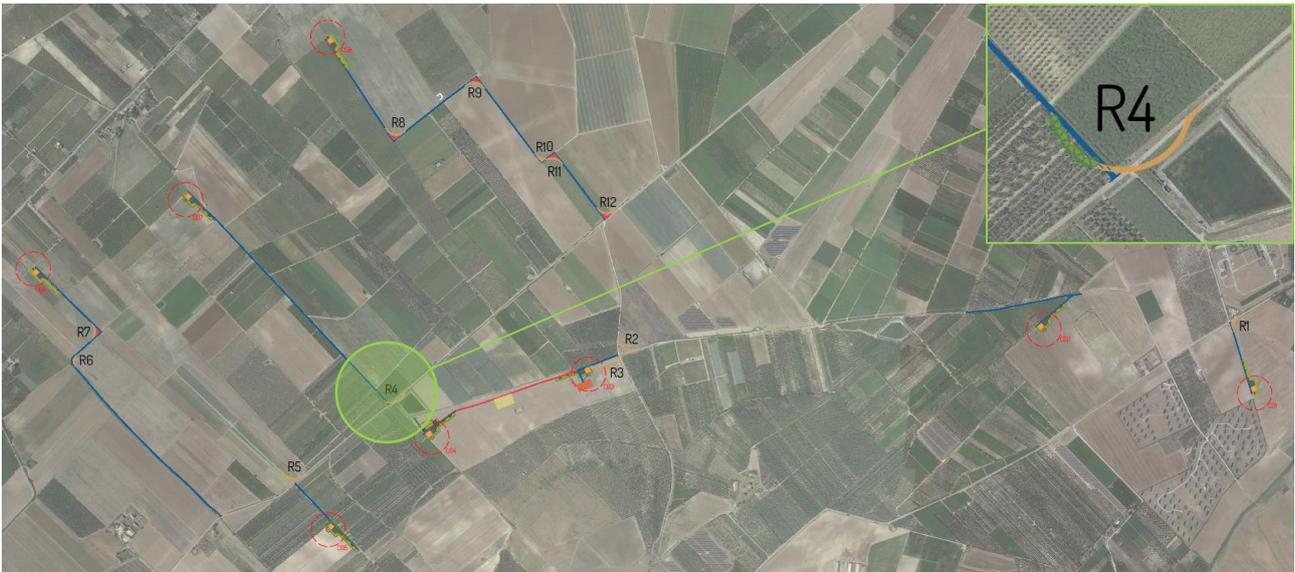
Figura 17: Ulivi da espantare per realizzazione viabilità di cantiere (R4) Rif. Elaborato EG.2.1
