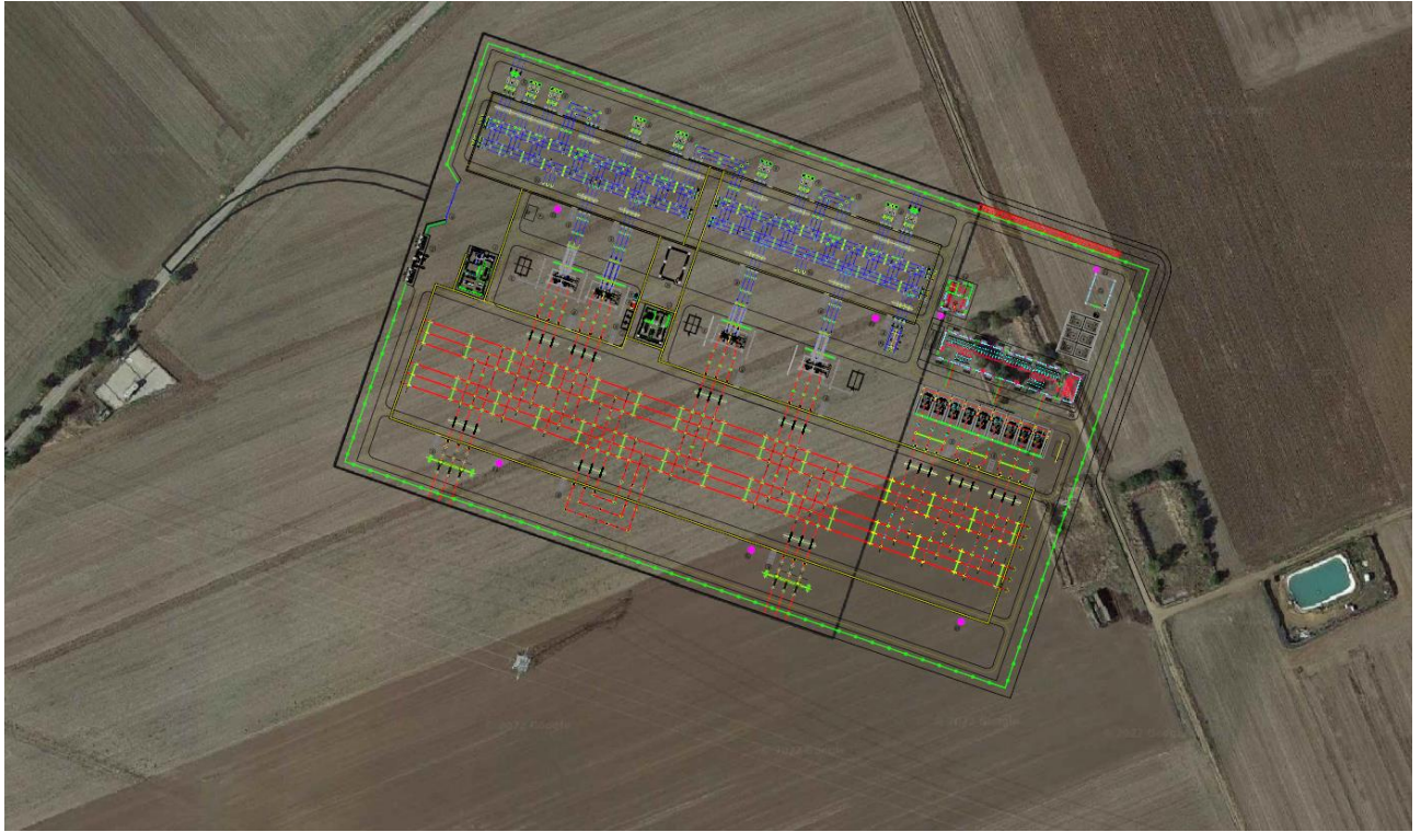
Figura 4: Stazione elettrica a 380/150/36 kV "Montemilone"
