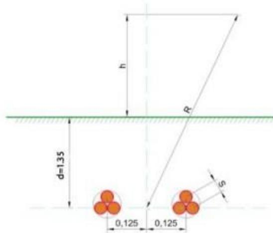
dove B [ $\mu$ T] è l'induzione magnetica in un generico punto distante R [m] dal centro del sistema (baricentro delle due terni di cavi), Si [m] è la distanza fra i conduttori adiacenti della terna i-esima, percorsi da correnti simmetriche ed equilibrate di ampiezza pari a Ii [A] (specifica della terna i-esima), x la distanza dall'asse y e viceversa.
