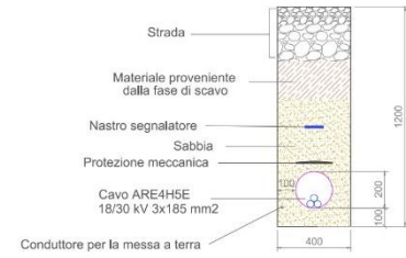
SEZIONE MT INTERNA IMPIANTO 1 terna 185 mm 2
