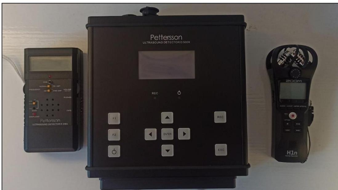
**Foto n. 1:** Attrezzatura utilizzata per il monitoraggio dei chirotteri. Da destra verso sinistra: Rilevatore a eterodina ed espansione temporale (x10 e x20 selezionabile). Bat detector D 500X per la registrazione prolungata in campo degli ultrasuoni . Registratore multitraccia collegato al D 240X.
