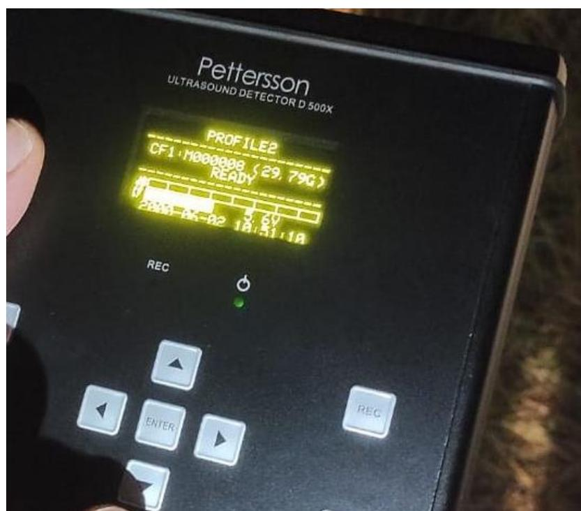
**Foto 2:** Preparazione del Bat Detector Petterson D500 x per i rilievi su postazione fissa prolungata. Il D500X è un'unità di registrazione a ultrasuoni destinata alla registrazione a lungo termine e incustodita delle chiamate dei pipistrelli. Contrariamente ai rilevatori di pipistrelli a espansione di tempo, il D500X
