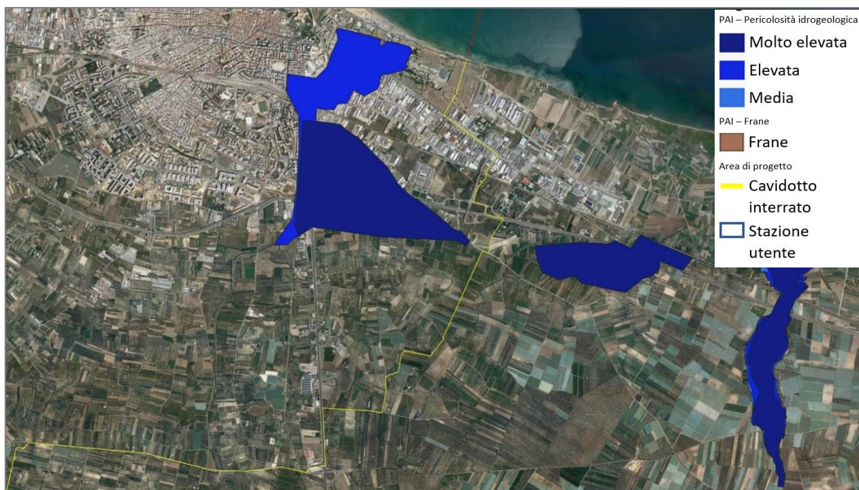
Figura 3.41 - Stralcio del PAI con sovrapposto il progetto nel tratto onshore (parte 1 di 3)
