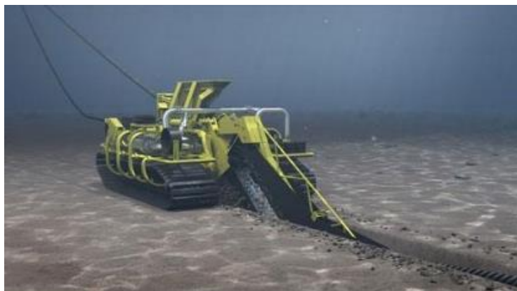
Figura 2.16 - Sistemi protezione dei cavi per interrimento
