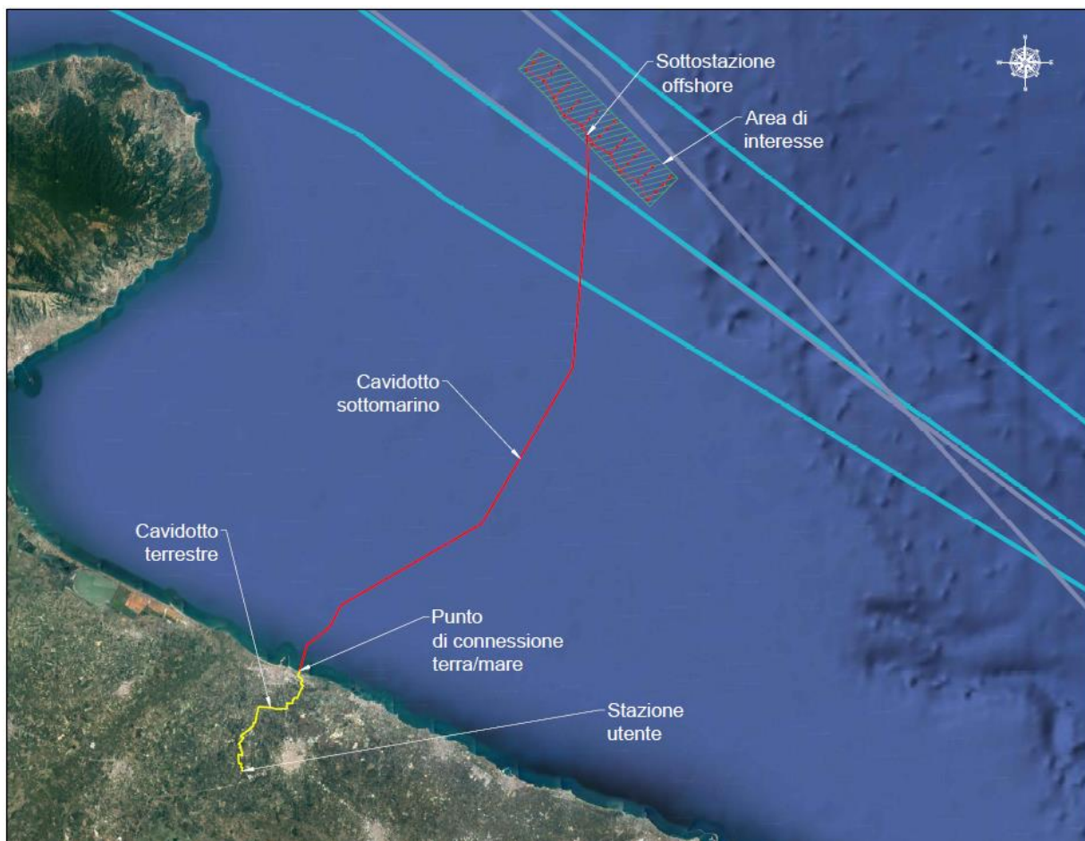
Figura 4.76 - Stralcio Tavola 36 – Inquadramento su rotte autostrade del mare (in ciano le rotte delle navi “miste” in viola i tratti delle navi merci)
