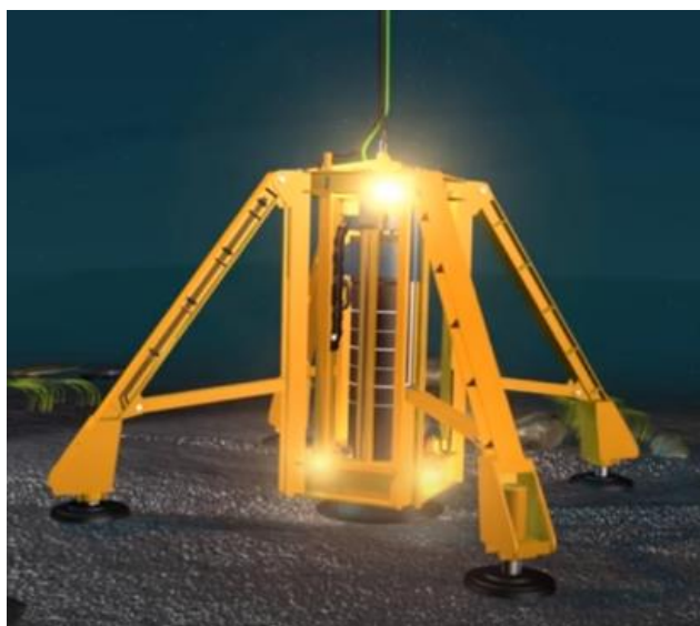
Figura 5-7 – Esempio di palo infisso nel fondale marino
