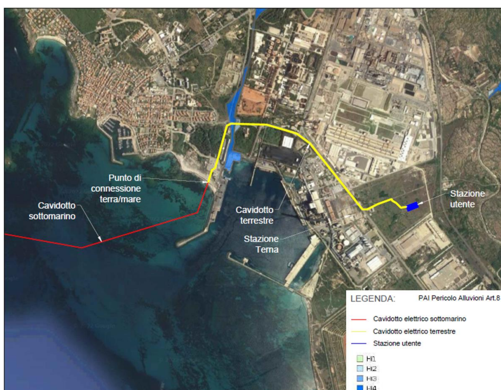
Figura 4-32 – il tracciato del cavidotto interferisce virtualmente con le fasce di pericolosità per alluvione del PAI: in realtà, non vi sarà alcuna interferenza dal momento che il primo passerà sotto strada, in sotterranea quindi, mentre le seconde disciplinano la superficie del paesaggio subaereo
