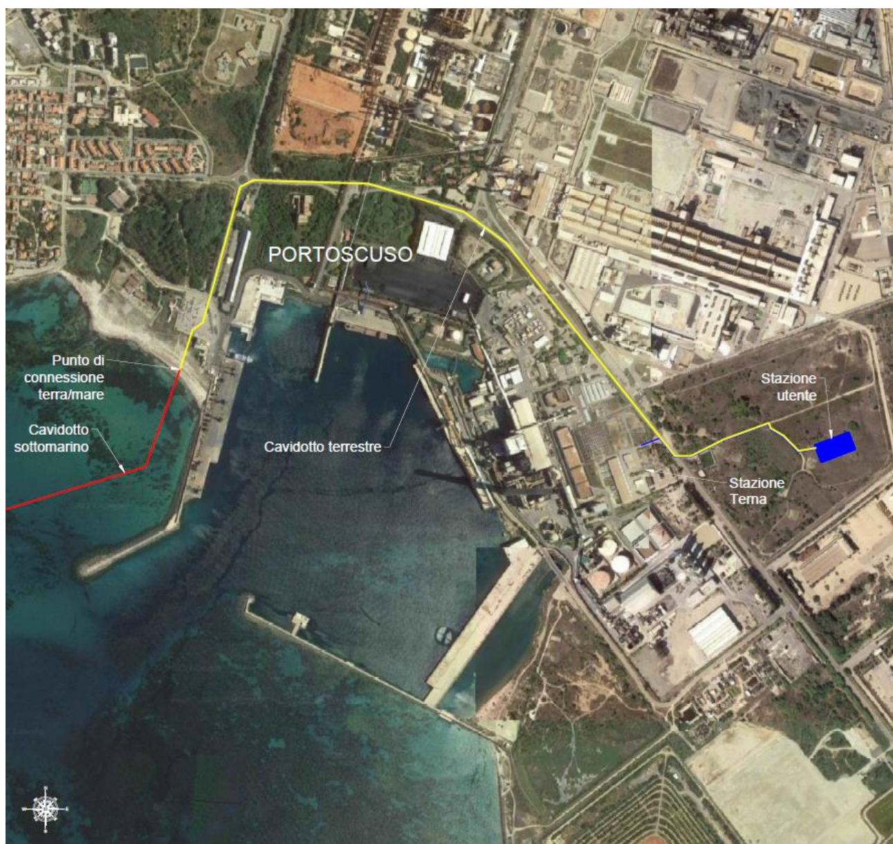
Figura 3.5 – Percorso terrestre dei cavi su ortofoto
