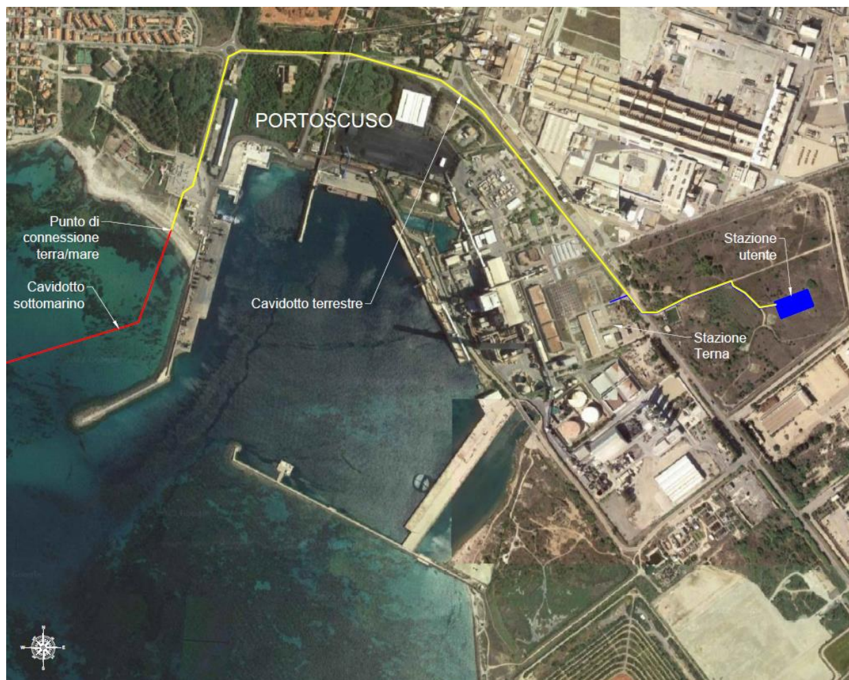
Figura 5-20 – Vista aerea del percorso del cavo di terra
