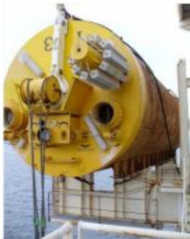
Figura 5-8 – Illustrazione di palo infisso per aspirazione
