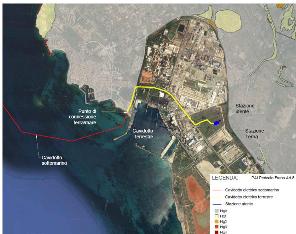
Figura 4-33 – il cavidotto elettrico terrestre rientra marginalmente all'interno dell'area a pericolosità da frana del PAI (art. 8) di livello Hg0
