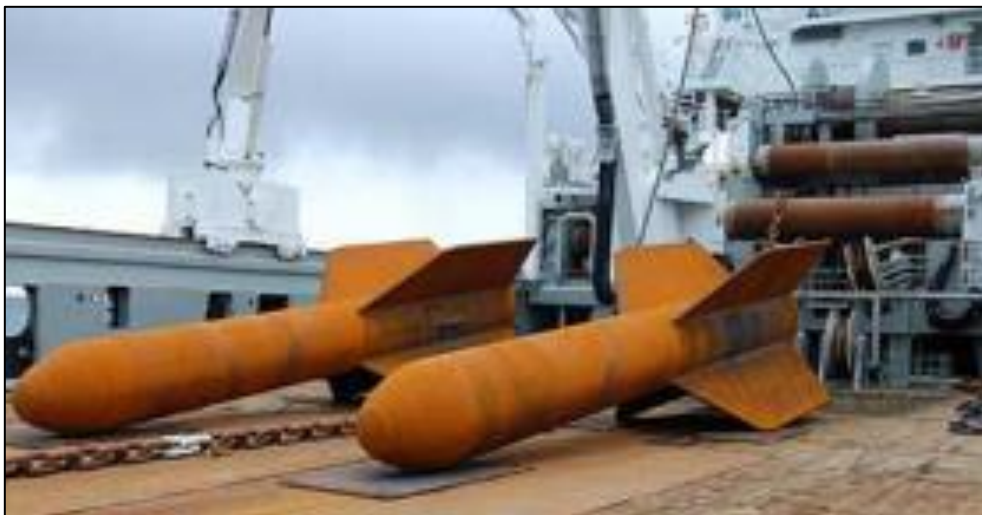
Figura 2-9 – Illustrazione di pali a siluro
