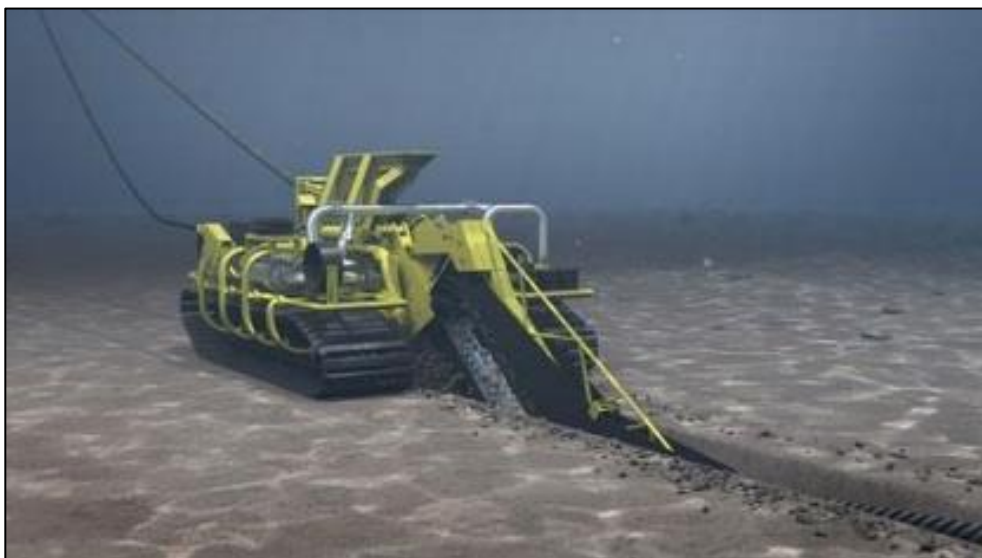
Figura 2-15 – Sistemi protezione dei cavi per interrimento
