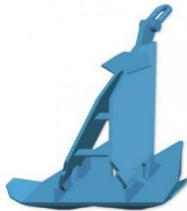
Figura 2-5 – Esempio di ancora con trascinamento
