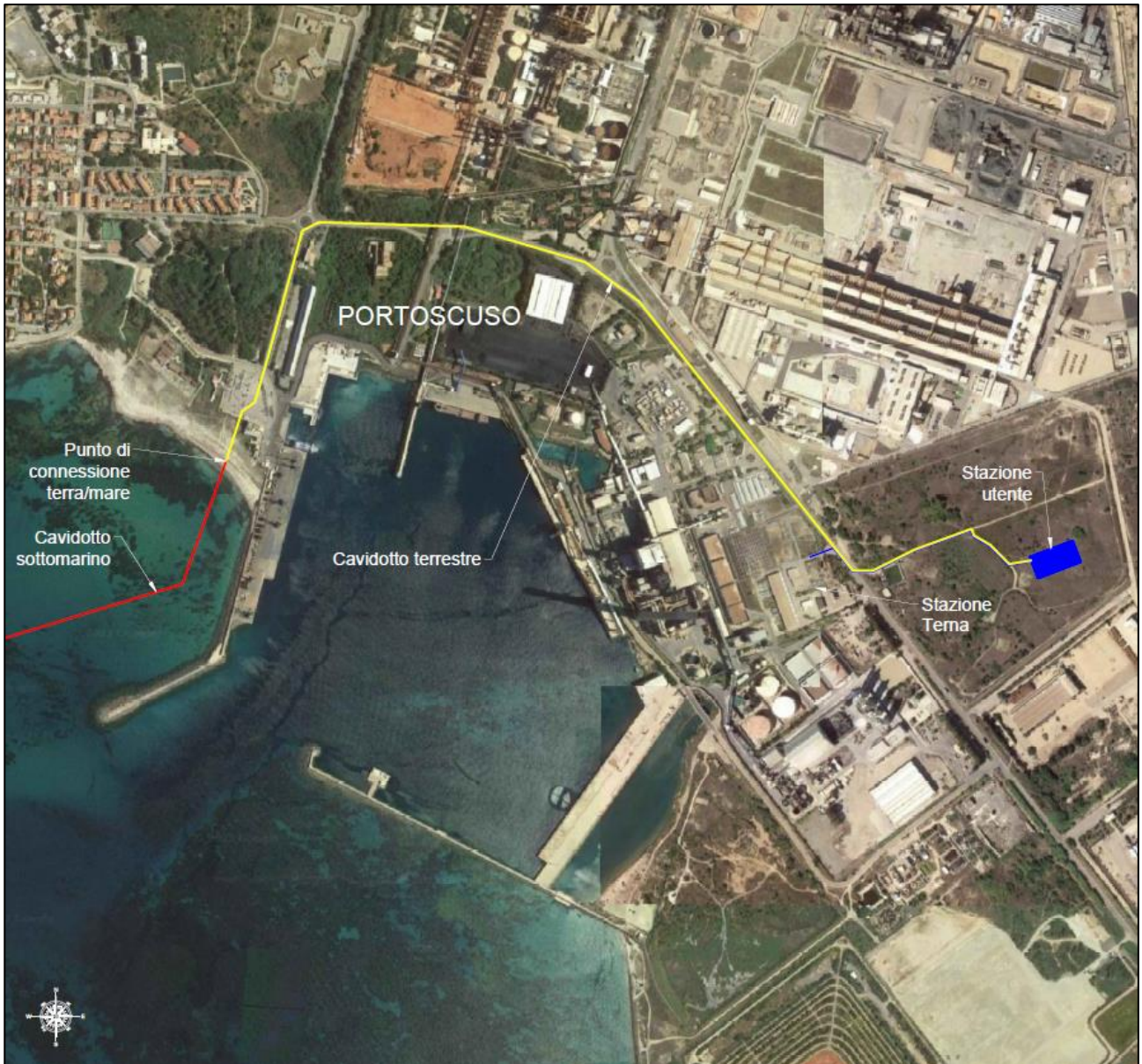
Figura 1-5 – Percorso terrestre dei cavi su ortofoto
