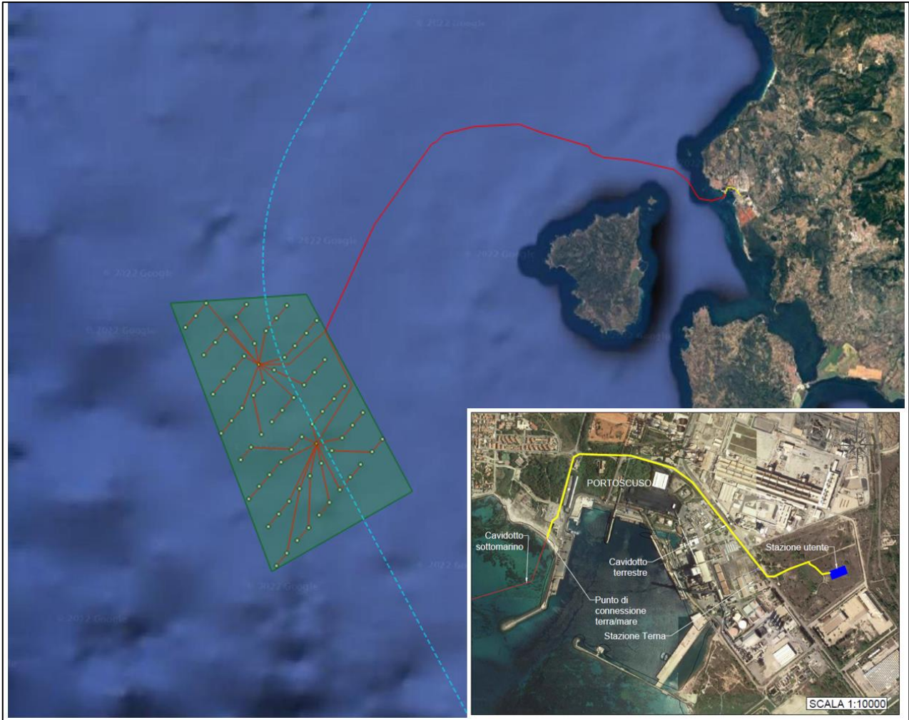
Figura 1-2 – Individuazione del parco eolico offshore e delle relative opere di connessione
