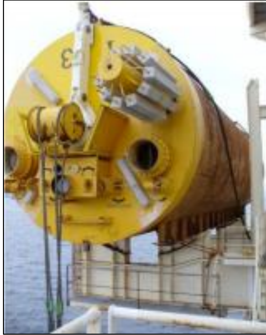
Figura 2-8 – Illustrazione di palo infisso per aspirazione
