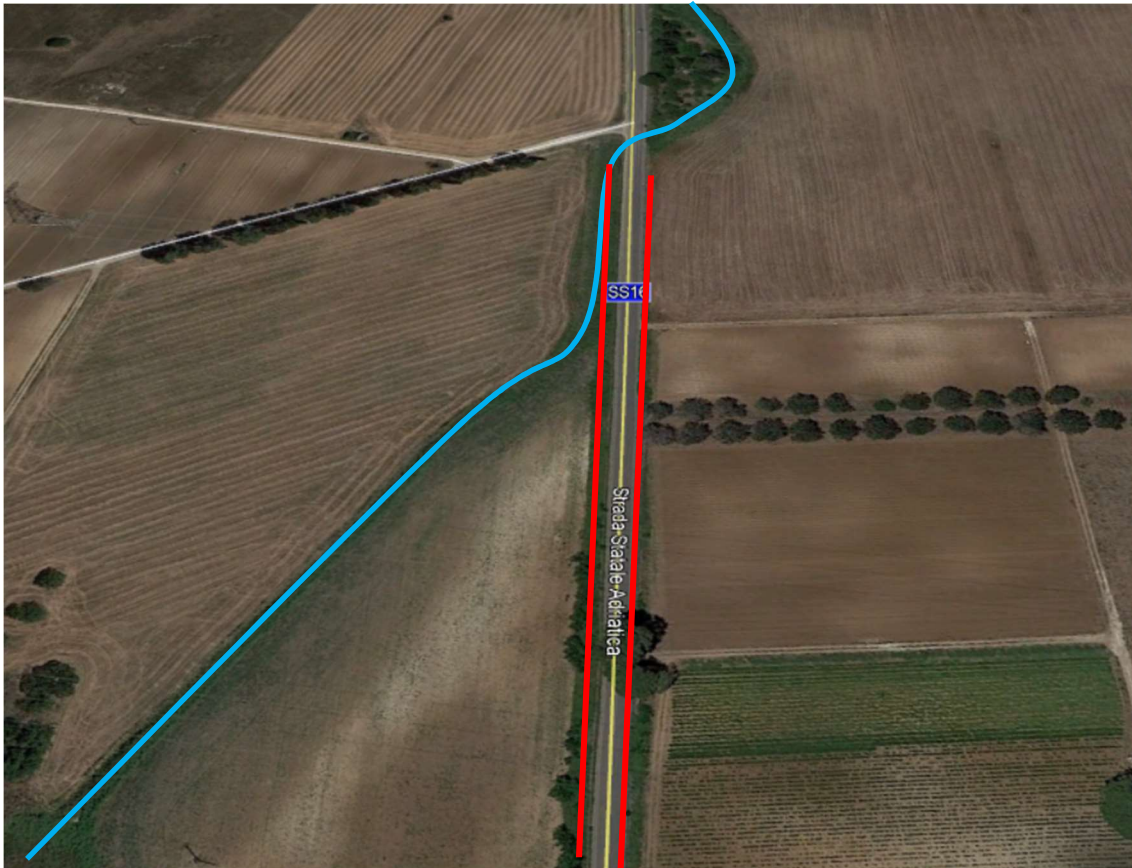
Fig. 32 – In blu è indicato l’andamento naturale del reticolo idraulico. Le linee rosse rappresentano le canalette di scolo della strada SS 16.
