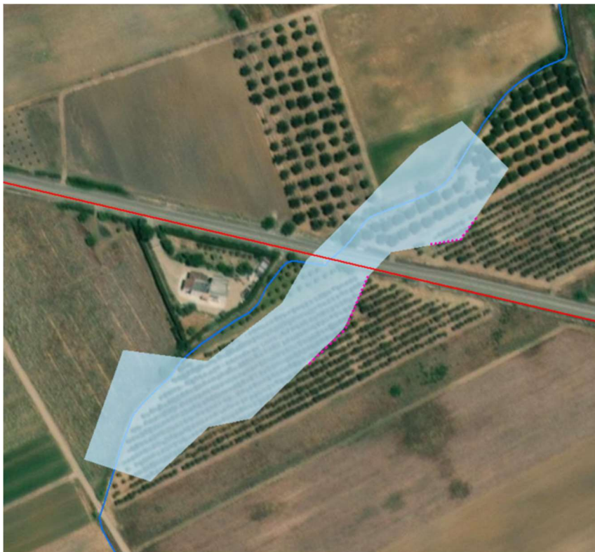
Fig. 52 – Ortofoto con fascia di allagamento dei 200 anni che interessa il cavidotto.
