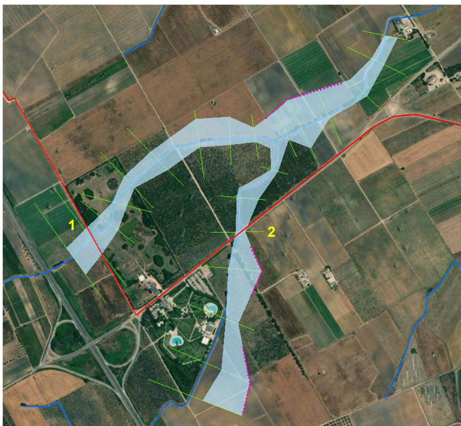
Fig. 45 – Ortofoto con fascia di allagamento dei 200 anni che interessa il cavidotto.
