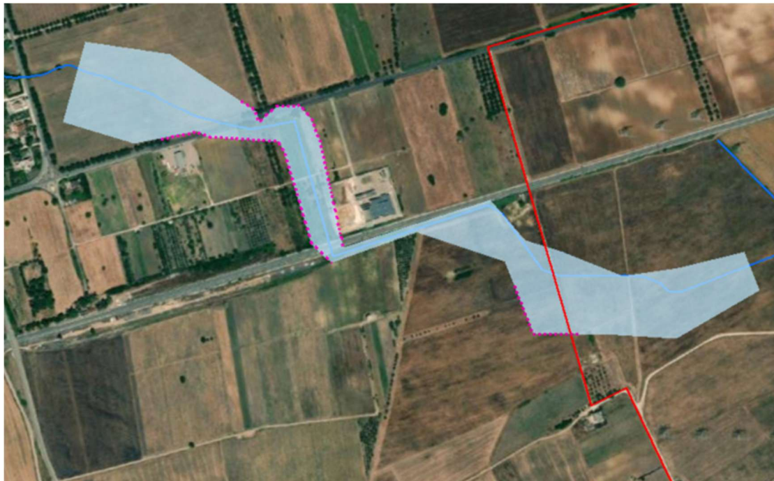
Fig. 40 – Ortofoto con fascia di allagamento dei 200 anni che interessa il cavidotto.
