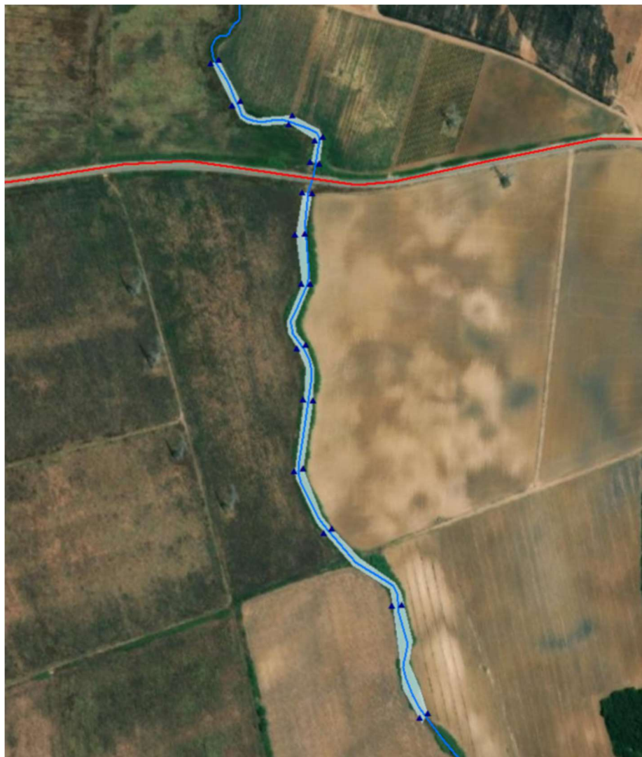
Fig. 14 – Stralcio Ortofoto con tratti di reticolo verificato idraulicamente. In rosso il tracciato del cavidotto.
