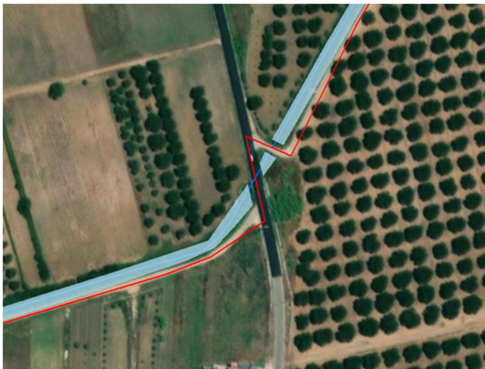
Fig. 26 – Foto google con evidenza del tracciato del cavidotto (in rosso) e la fascia di allagamento dei 200 anni (in celeste).
