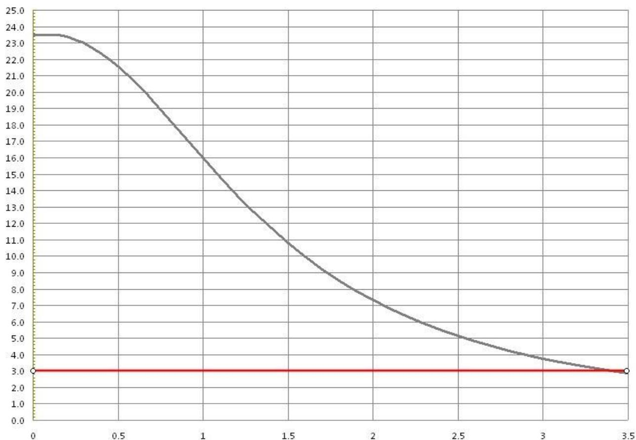
Valore dell’induzione magnetica al suolo del cavidotto MT nel tratto a 3 terne con disposizione in piano.
