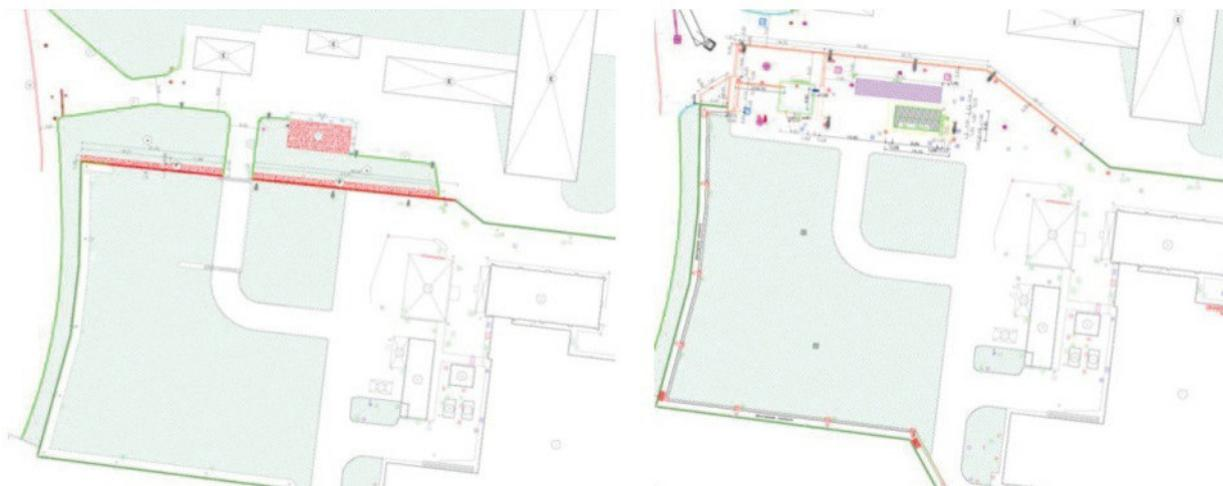
Fig. 6a-b. Nuova recinzione dell'impianto Plutonio: a sinistra planimetria *ante operam* con in rosso tratto di recinzione da demolire (stralcio da elaborato CS I 00415); a destra planimetria *post operam* con in arancione nuova recinzione e fabbricati da costruire (stralcio da elaborato CS I 00416).
