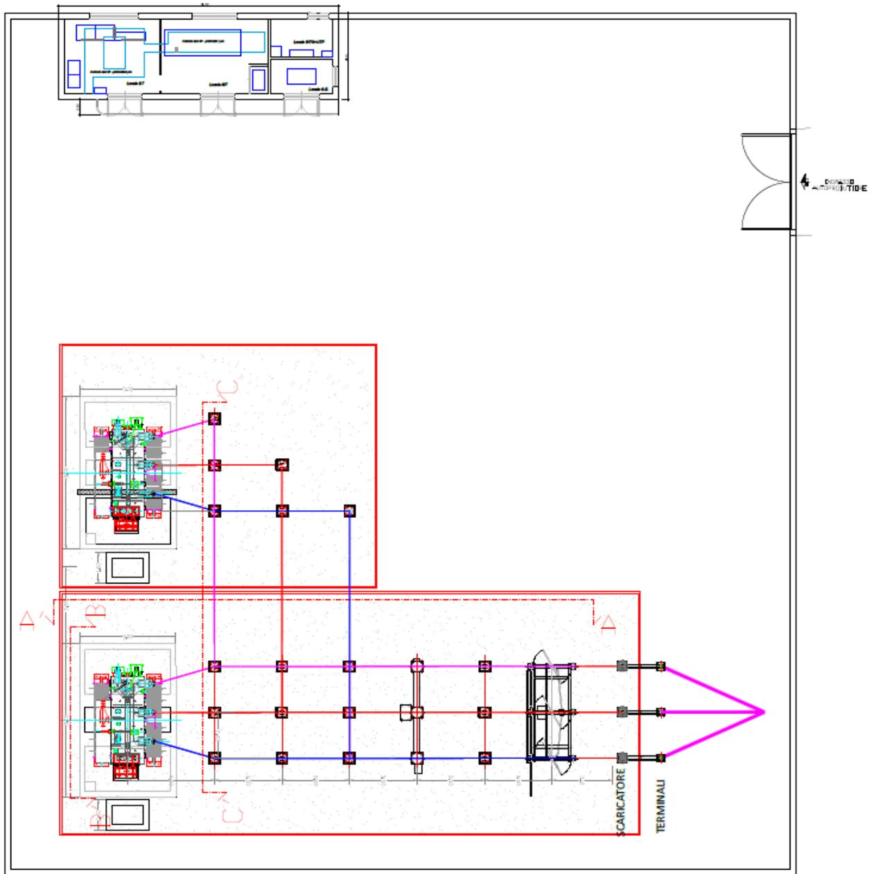
**Figura 2.5-3: Stazione elettrica utente – schema planimetrico**
