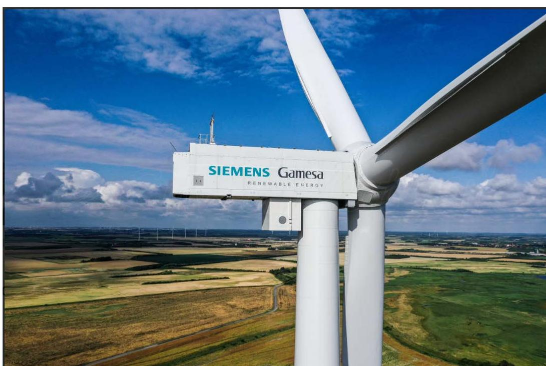
Figura 5: navicella del modello Siemens-Gamesa SG 170
