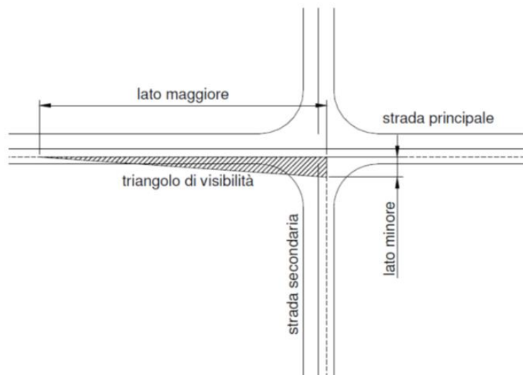
Figura 4.1 Schema di verifica dei triangoli di visibilità delle intersezioni - D.M. 19/04/2006
