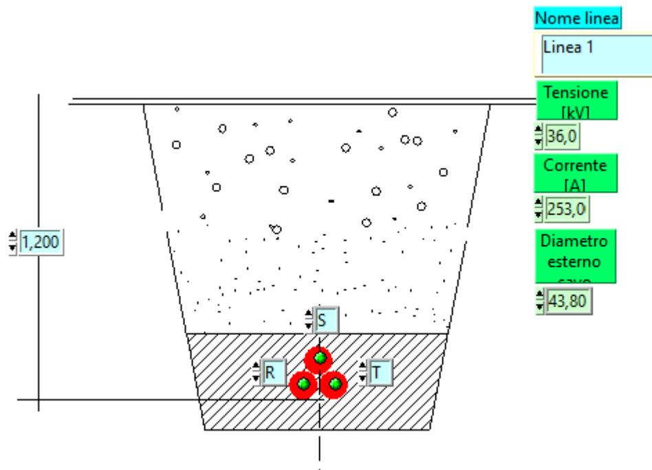
Figura 2. Posa cavo 36 kV da 120 mm<sup>2</sup>
