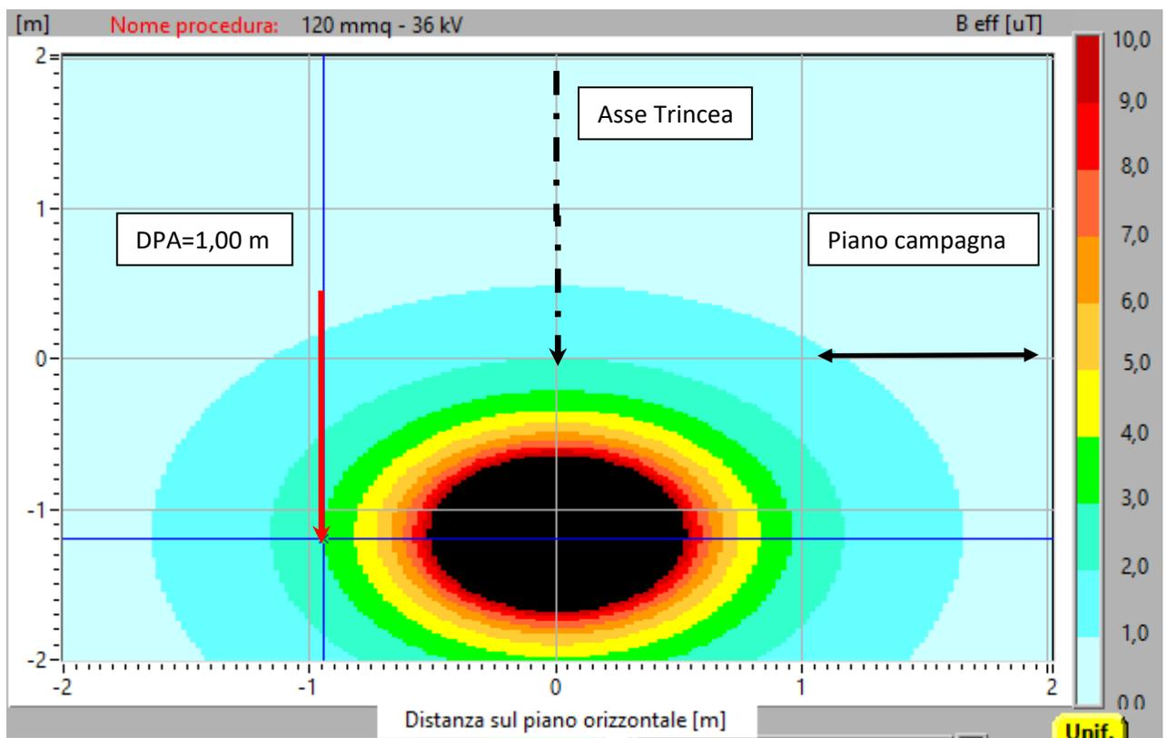
Figura 9. Mapa verticale induzione magnetica (B) sezione tipo con indicazione della DPA - V=36 kV - 1 cavo 120 mm<sup>2</sup>
