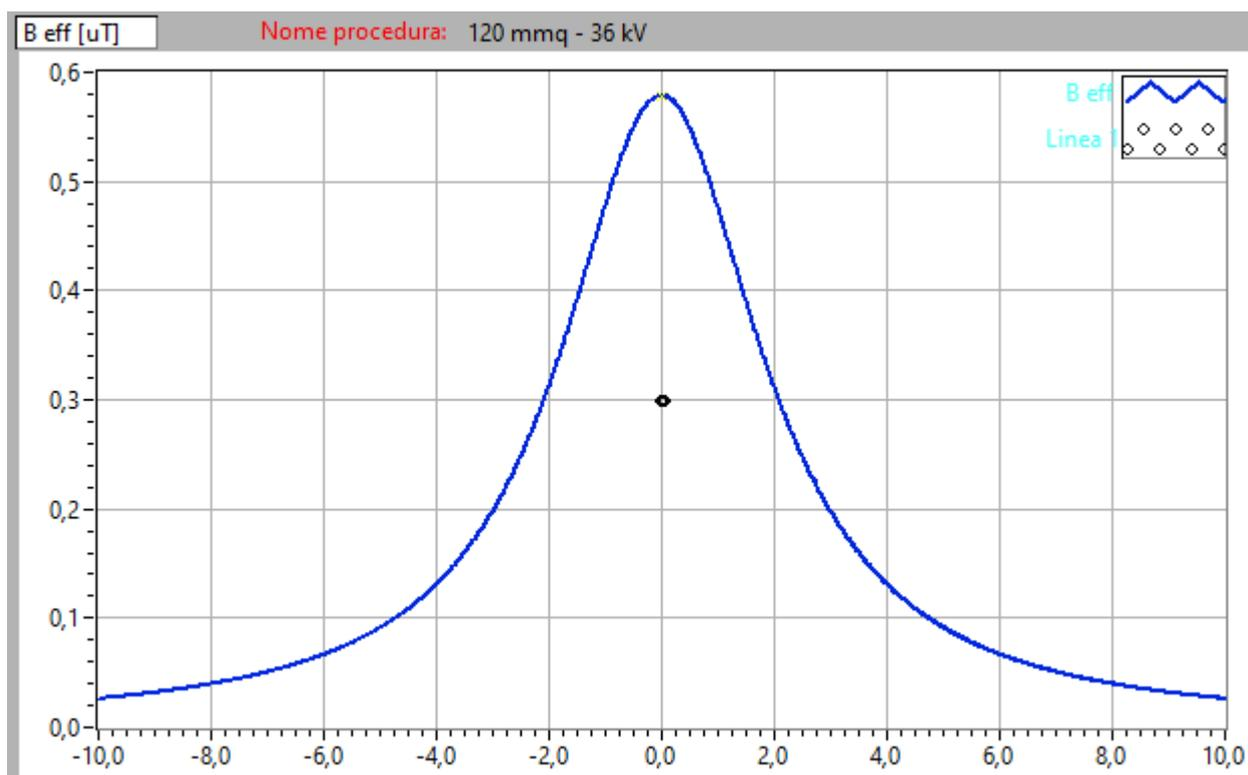
Figura 3. Profilo laterale induzione magnetica (B) a 1 m da terra- V=36 kV- B=0,57  $\mu\text{T}$ - 1 cavo 120 mm<sup>2</sup>
