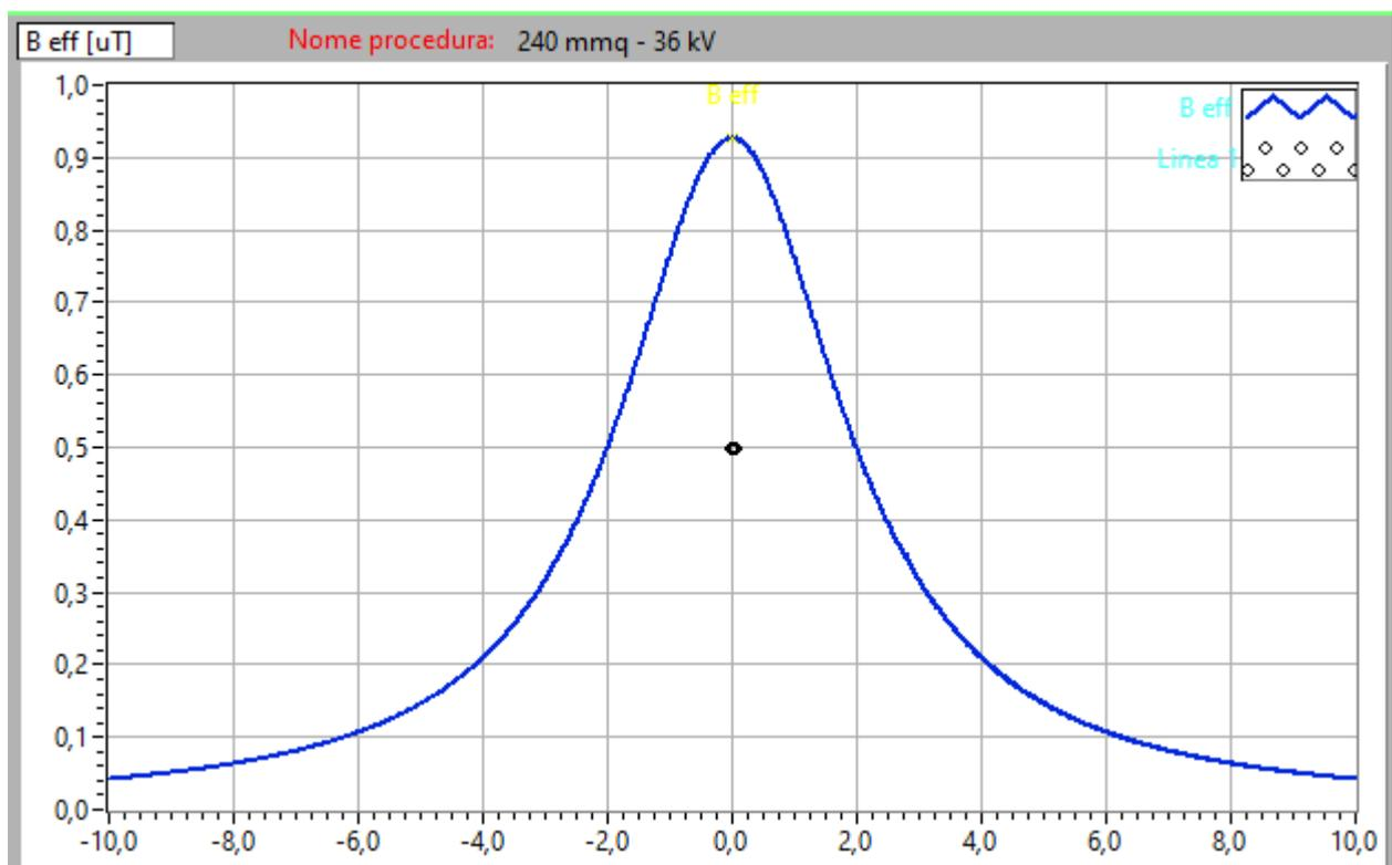
Figura 5. Profilo laterale induzione magnetica (B) a 1 m da terra- V=36 kV – B=0,93 µT- 1 cavo 240 mm<sup>2</sup>
