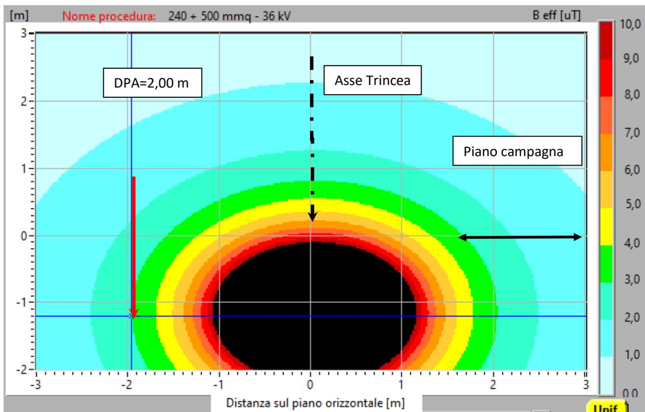
Figura 13. Mapa verticale induzione magnetica (B) sezione tipo con indicazione della DPA - V=36 kV – 240 + 500 mm<sup>2</sup>
