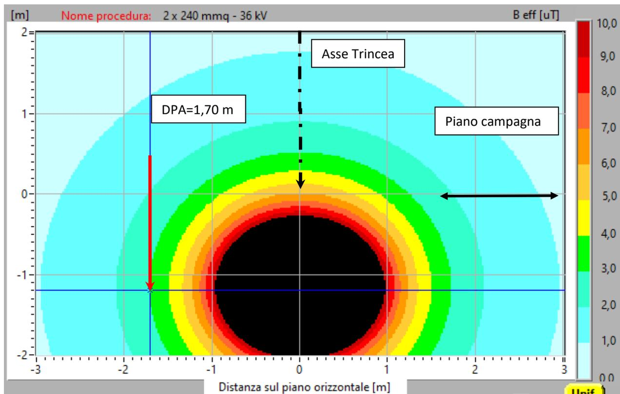
Figura 12. Mapa verticale induzione magnetica (B) sezione tipo con indicazione della DPA - V=36 kV - 2 cavi 240 mm<sup>2</sup>
