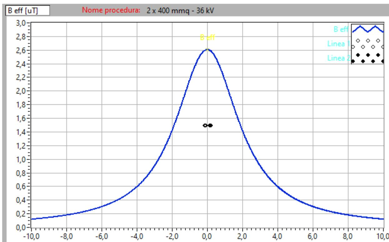
Figura 8. Profilo laterale induzione magnetica (B) a 1 m da terra- V=36 kV – B=2,51 μT- 2 cavi 400 mm<sup>2</sup>
