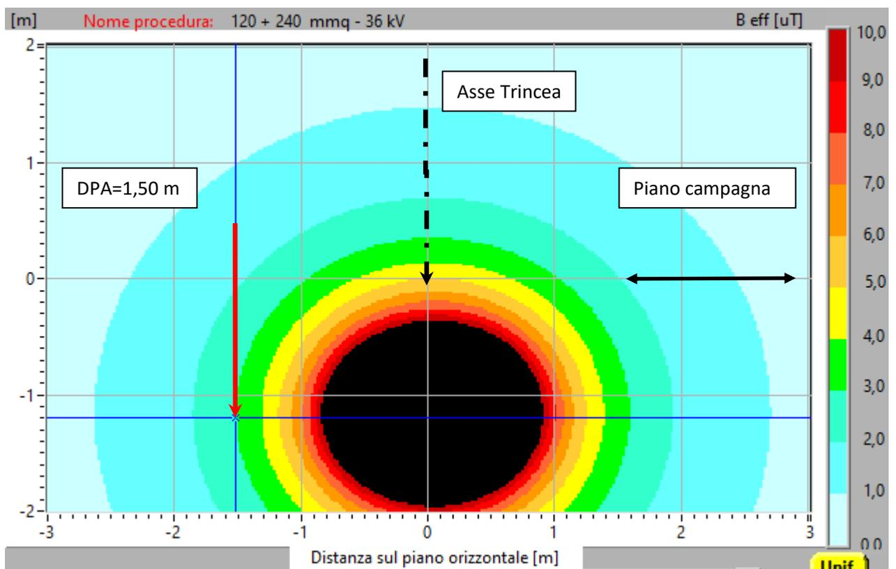
Figura 10. Mapa verticale induzione magnetica (B) sezione tipo con indicazione della DPA - V=36 kV - 120 + 240 mm<sup>2</sup>
