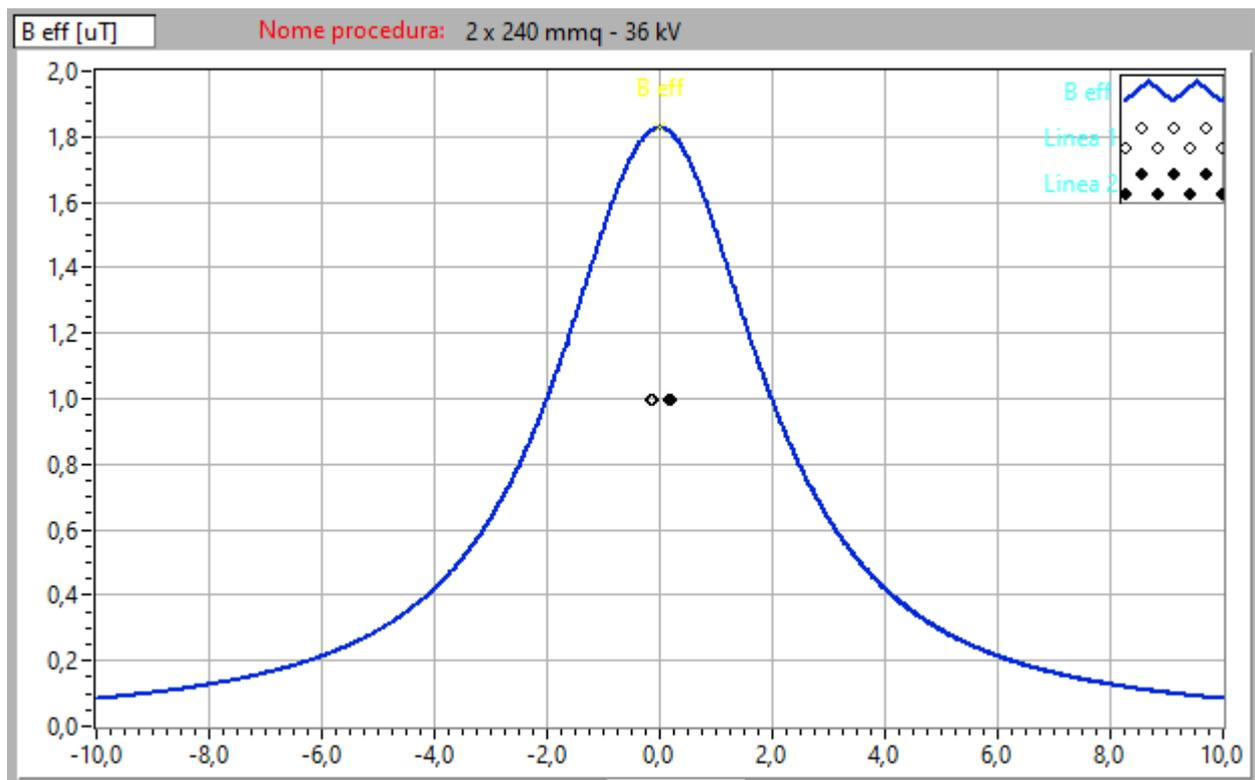
Figura 6. Profilo laterale induzione magnetica (B) a 1 m da terra- V=36 kV – B=1,83  $\mu$ T- 2 cavi 240 mm<sup>2</sup>
