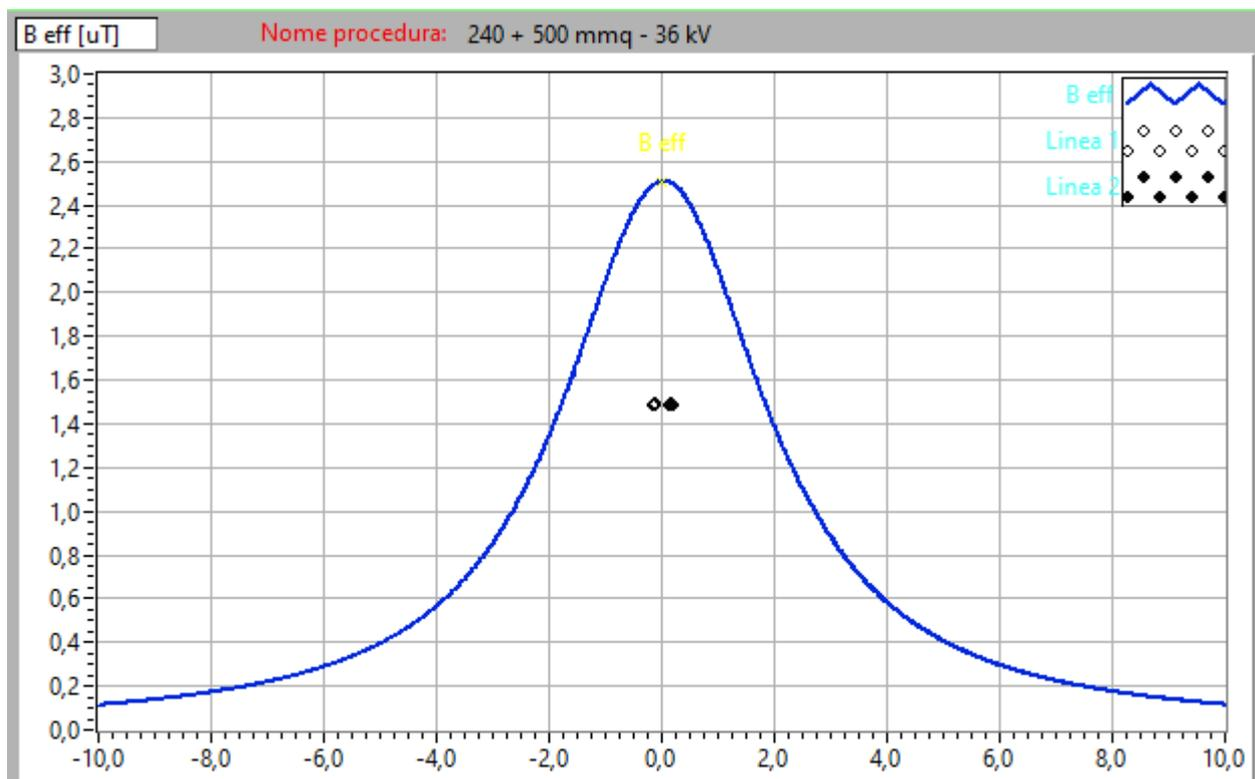
Figura 7. Profilo laterale induzione magnetica (B) a 1 m da terra- V=36 kV – B=2,51  $\mu$ T- 1 cavo 240 + 1 cavo 500 mm<sup>2</sup>
