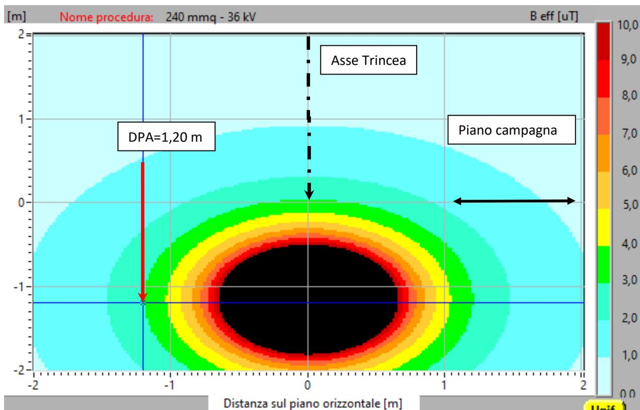
Figura 11. Mapa verticale induzione magnetica (B) sezione tipo con indicazione della DPA - V=36 kV - 1 cavo 240 mm<sup>2</sup>
