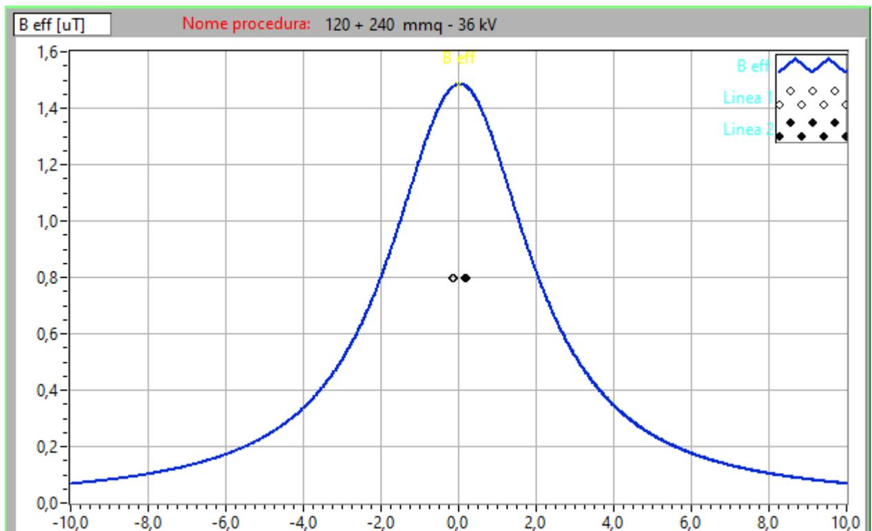
Figura 4. Profilo laterale induzione magnetica (B) a 1 m da terra- V=36 kV – B=1,48 µT- 1 cavo 120 + 1 cavo 240 mm<sup>2</sup>
