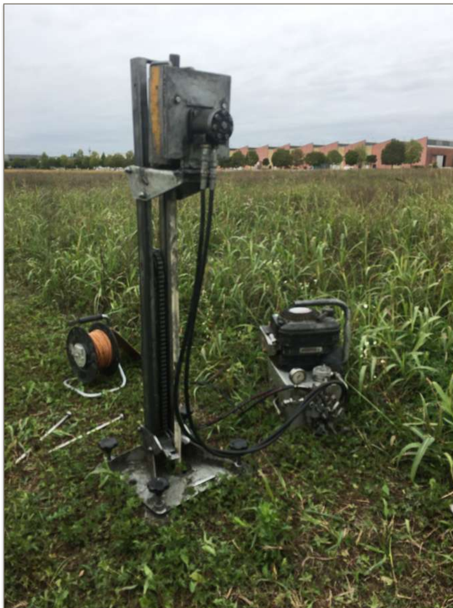
Esecuzione Prova DPM_4 in data 28.09.2022
