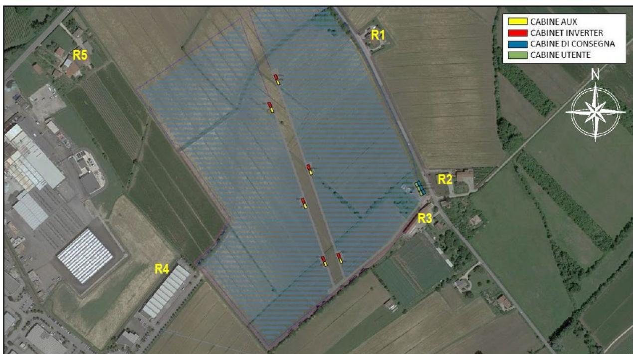
Figura 5-2 – Estratto planimetria di progetto con l'indicazione della posizione delle sorgenti sonore
