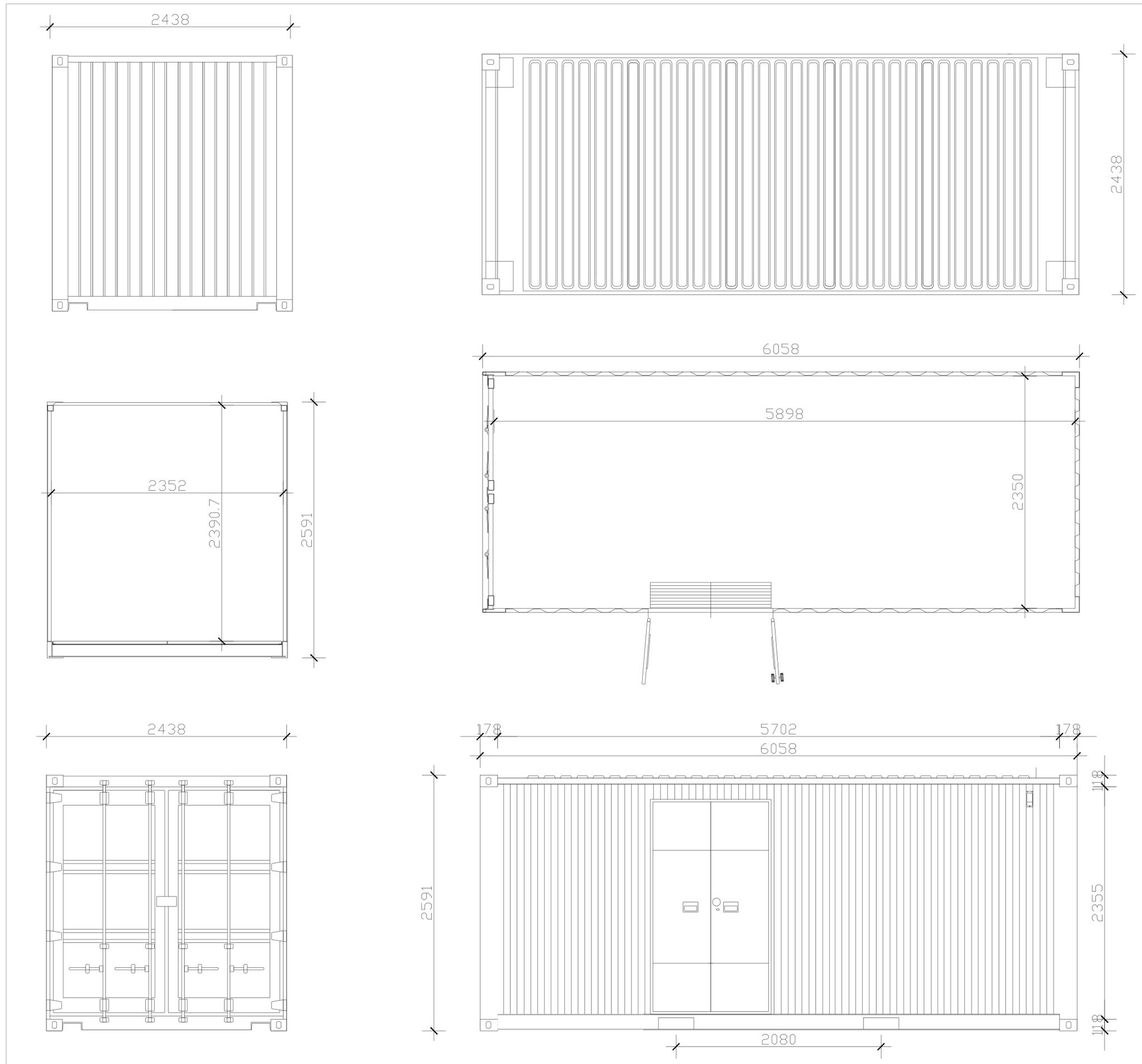
Il campo fotovoltaico ospiterà inoltre due cabine in pre fabbricato che fungeranno da magazzino e raccolta quadri di BT per funzionamento ausiliari.
