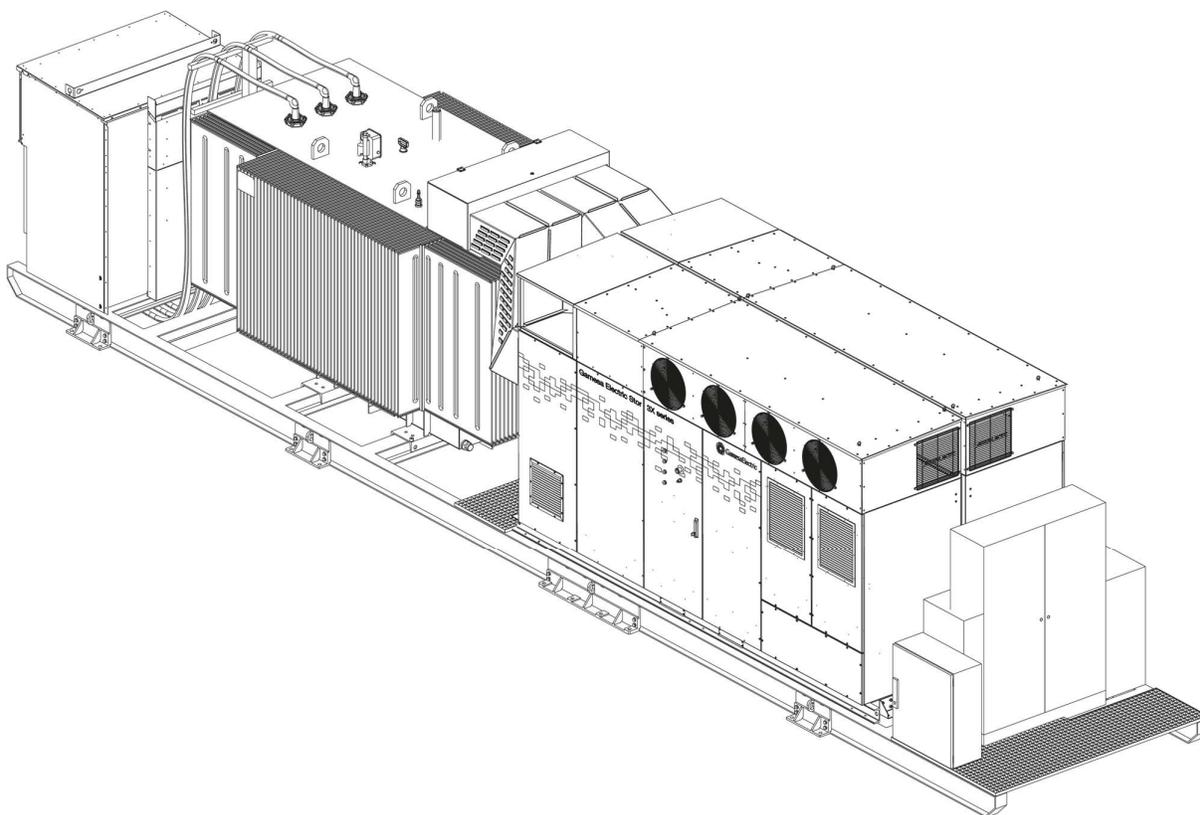
*Figura 3: rappresentazione dello skid dotato sia di trasformatore che di inverter centralizzato.*
