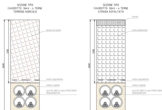
Figura 5: Modalità di posa cavi a 36kV di collegamento alla SE 132-36 COSTA.
