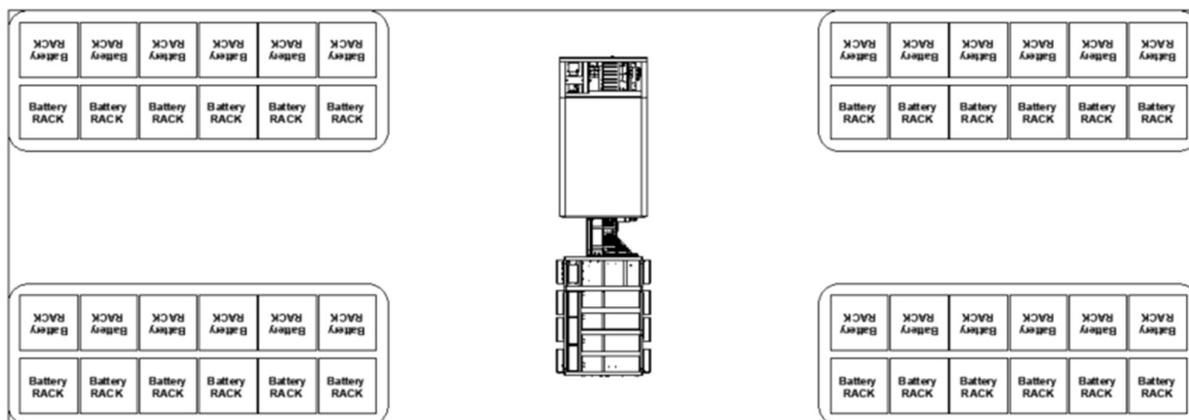
Figura 7: rappresentazione di un modulo BESS.
