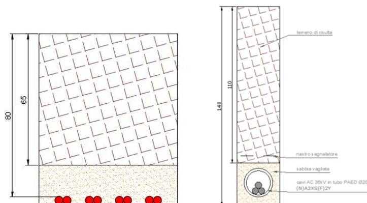
Figura 4: Particolare di posa dei cavi DC e dei cavi a 36kV interni al campo.
