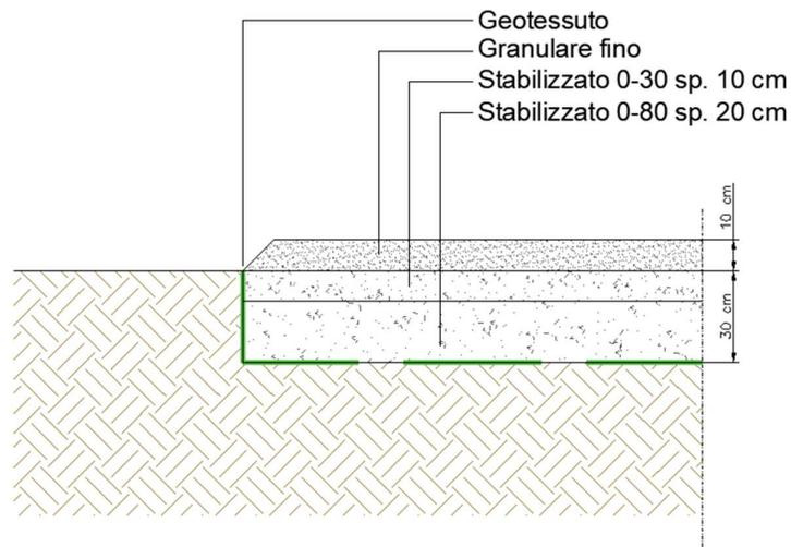
Figura 12 - Sezione tipo viabilità interna all'impianto e piazzali
