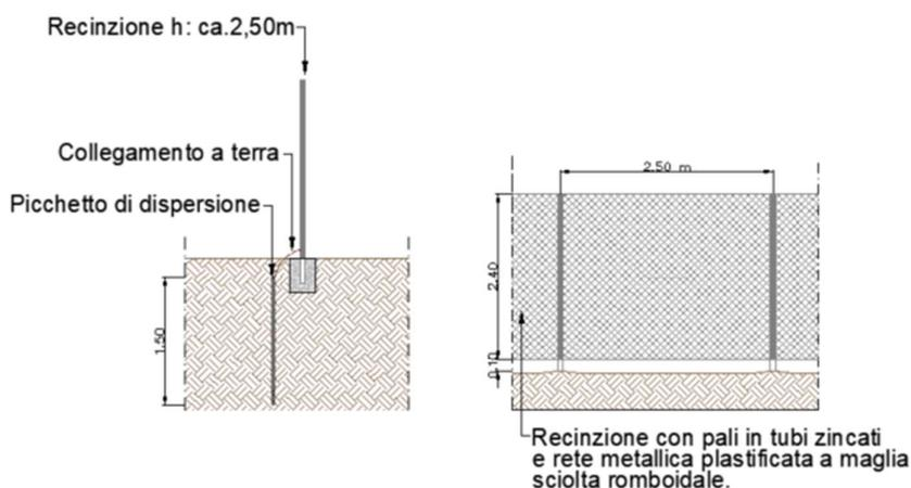
Figura 13 - Rappresentazione della recinzione prevista di altezza pari a 2.5m
