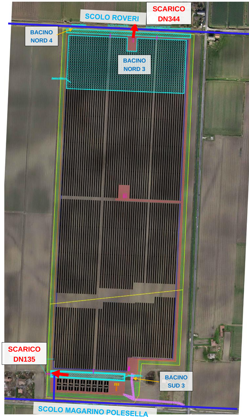
Figura 7.3 - Schema impianto drenaggio acque meteoriche – Impianto OVEST
