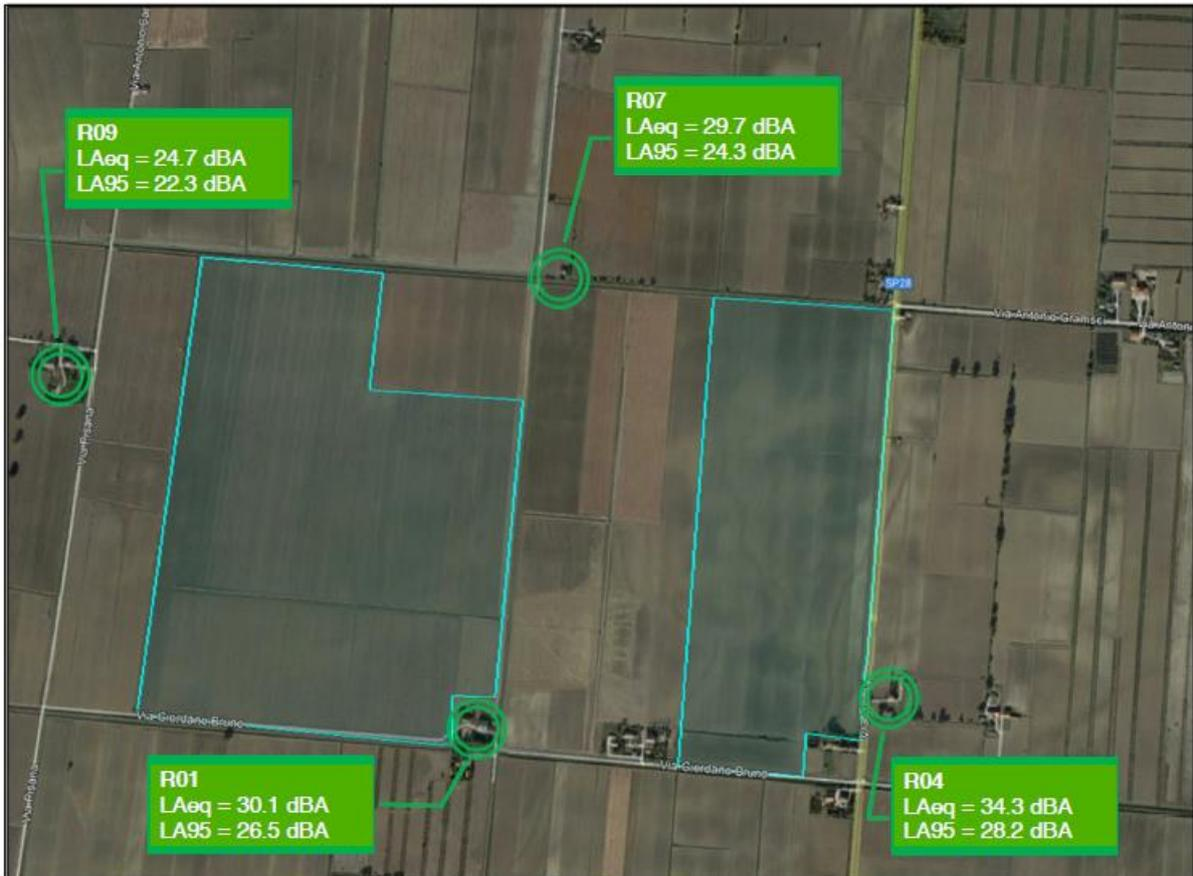
Figura 5 - Ortofoto con individuazione delle posizioni di misura e dei livelli di clima acustico misurati in ante operam
