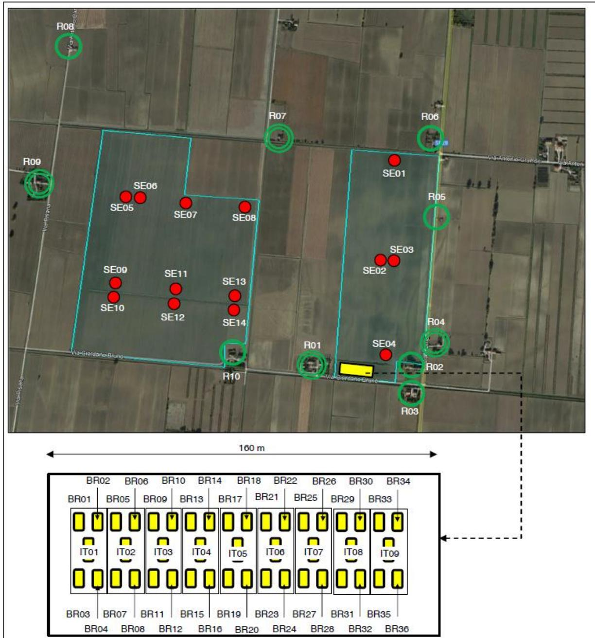
Figura 4 - Foto aerea dell'area di influenza dell'Impianto agrivoltaico (SE= skid di trasformazione FV) e zoom sulla centrale di accumulo
