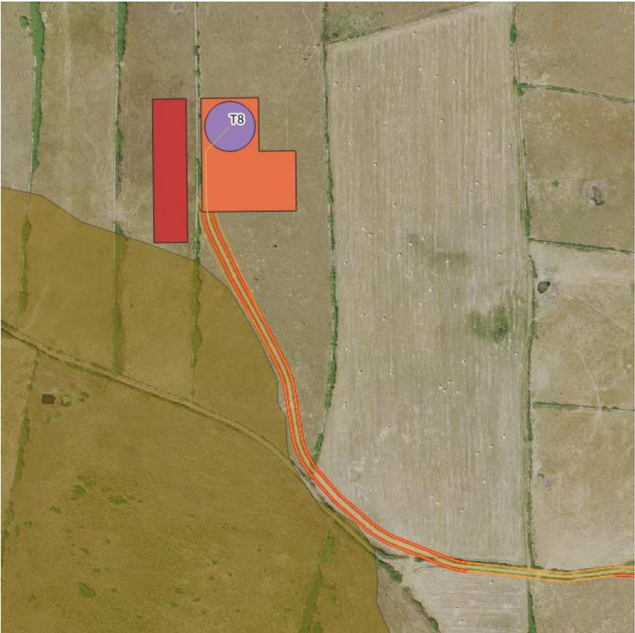
*Figura 2.1 – Viabilità di accesso alla postazione eolica T08 e confini del perimetro degli apparati vulcanici con denominazione “Monte Pelau”, riconosciuto come vincolo paesaggistico ai termini dell’art. 142 c. 1 lettera I) del Codice Urbani*
